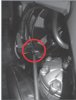
Schraube, mit der die Spulenhaltung am Kühler befestigt ist.
