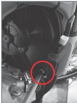
Entfernen Lichtschalter/Druckschalter Dual-Mapping
