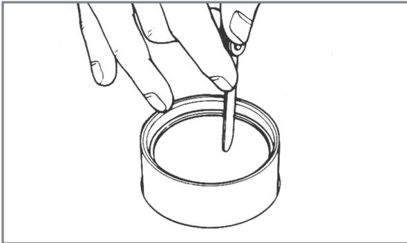
Erste Prüfung der Kolbenringe.
