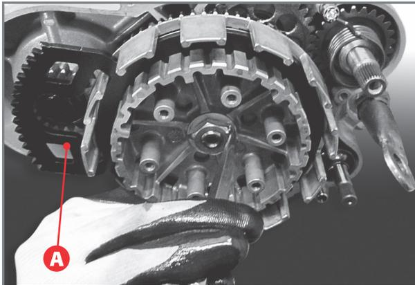
Öffnen der Federkeile der Sicherungsscheibe.
