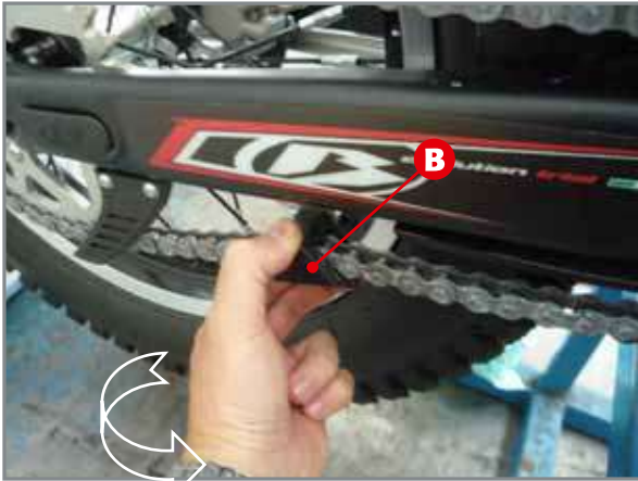
Einsatz des Ritzels in die Ausgangswelle.
