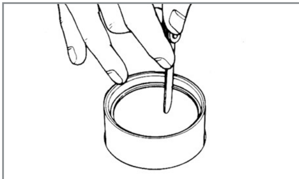
Erste Prüfung der Kolbenringe.
