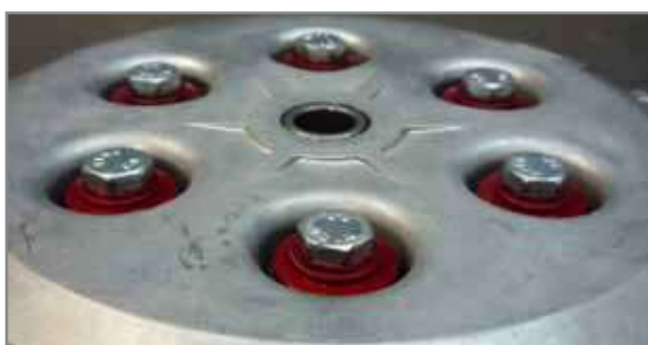
Positionierung Unterlegscheiben Kupplung in Konfiguration A
