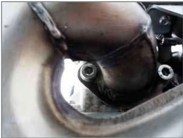
Die beiden Flanschschrauben Abgaskrümmers.
