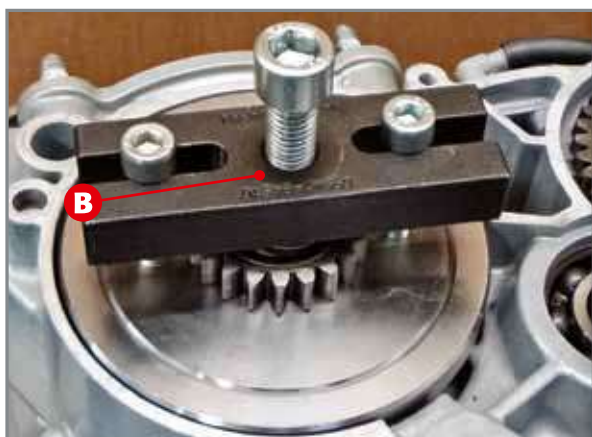
Ausbau des Hauptzahnrad in der Version 200cc, 250 cc und 300cc.
