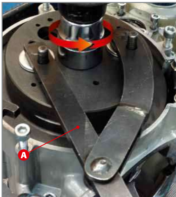
Blockierung des Schwungrads mit Hilfe eines Universalwerkzeugs.
