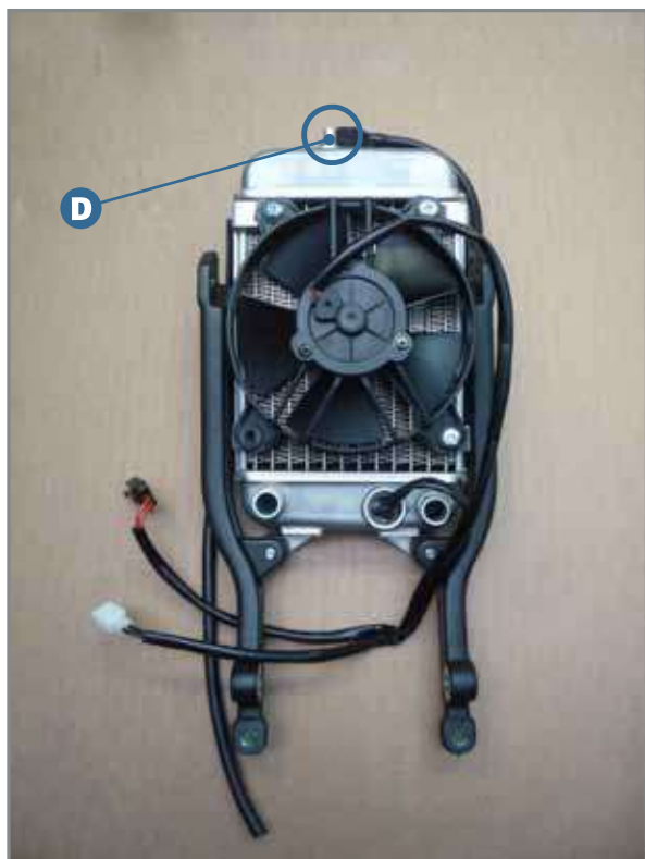
Kühler komplett: markiert ist der obere Stift D.
