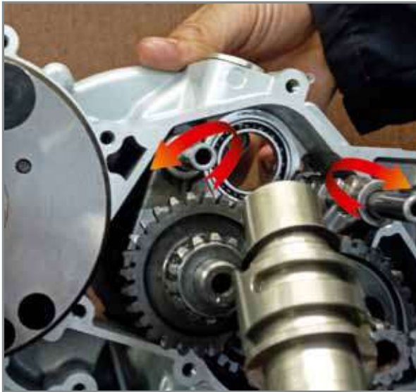
Drehung nach außen, der Gruppen Gabel-Bolzen und Einsatz der Schaltwalzenvorrichtung.
