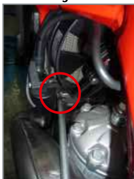
Schraube, mit der die Spulenhalterung am Kühler befestigt ist.
