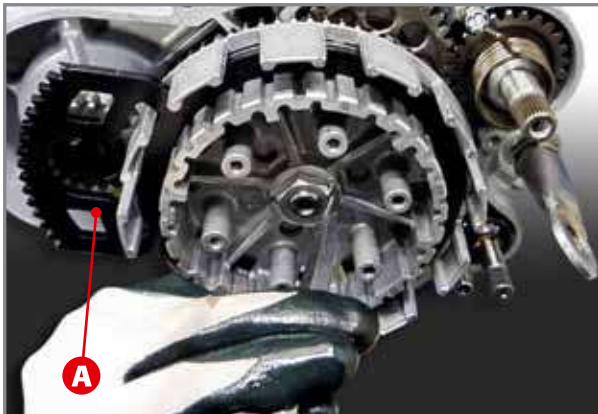
Öffnen der Federkeile der Sicherungsscheibe.
