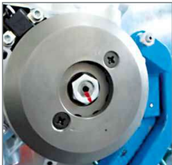
Entkopplung des Schwungrads von der Kurbelwelle über eine Entnahmevorrichtung B (Art. nr. 1480210.000).
