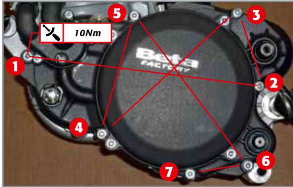
Anordnung der Schrauben auf dem internen Kupplungsdeckel.
