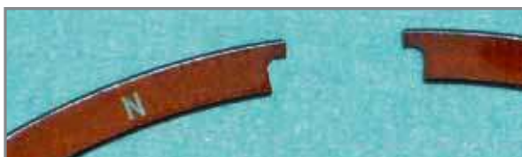
Auf die Pleuellager aufgestempelter Buchstabe.
