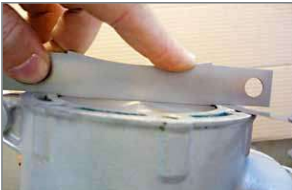
Beispiel, bei dem der Kolben die Einstelllehre nach oben drückt.
