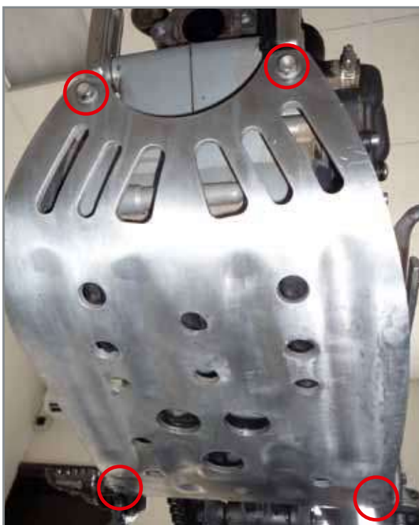
Die vier Schrauben der Motorschutzplatte.
