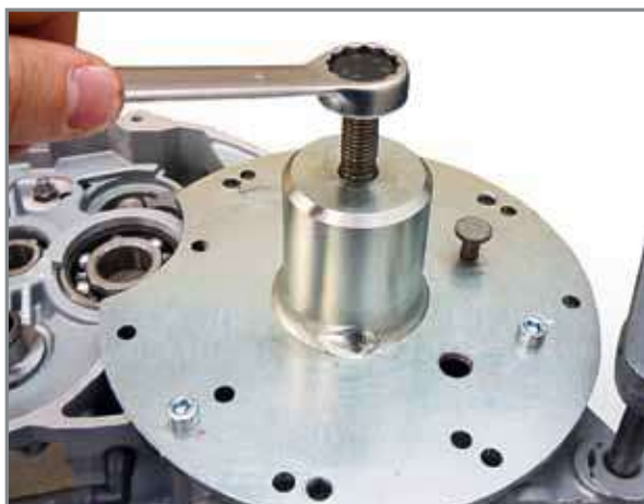
Ausbau der Kurbelwelle.
