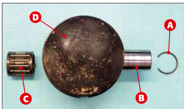
Kompletter Kolben. A) Bolzenfeststellring; B) Zapfen; C) Lagerkäfig; D) Kolben.
