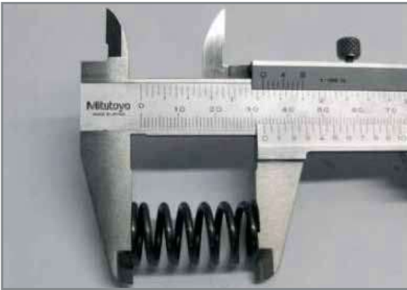
Mindestlänge der Kupplungsfedern.
