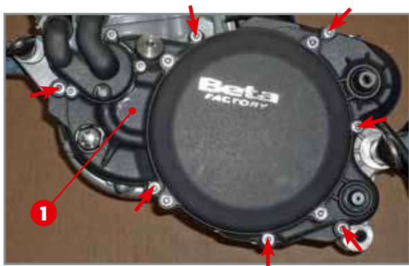
Die sieben Schrauben, mit denen der Innendeckel der Kupplung am Gehäuse befestigt wird.
