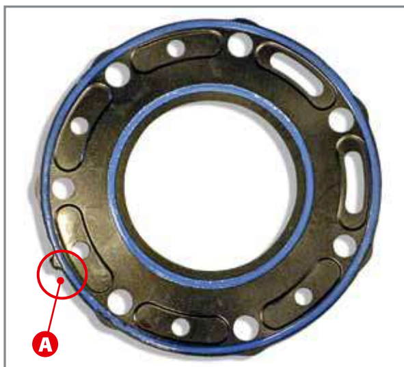
Zylinderkopfdichtung mit Montagebezug.
