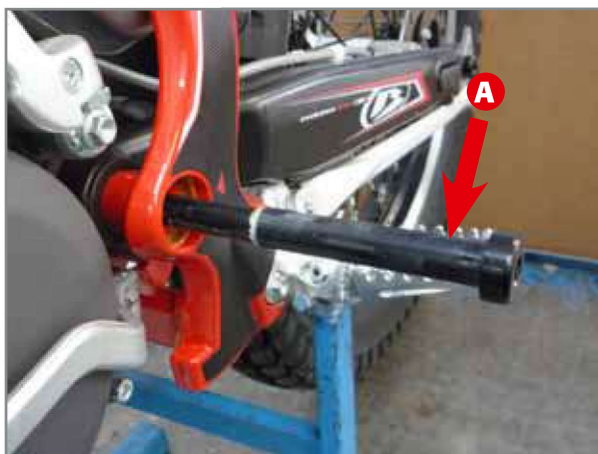
Nicht vollständig herausgezogener Schwingenbolzen.
