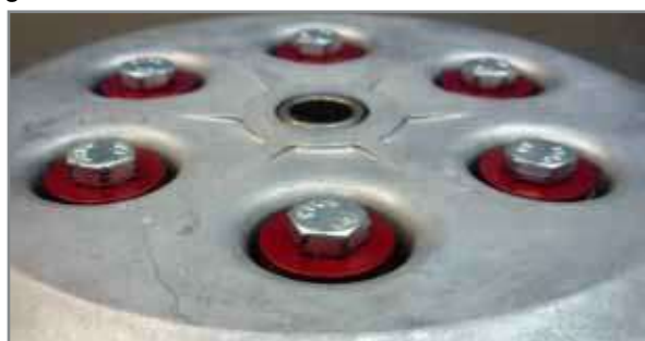
Positionierung Unterlegscheiben Kupplung in Konfiguration B
