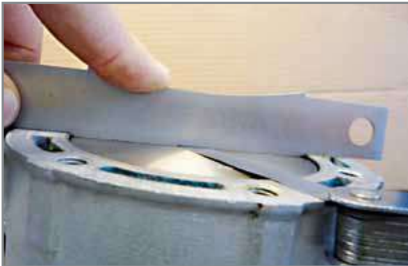
Beispiel, bei dem der Kolben die Einstelllehre nicht berührt. Messen des Abstands mit Dickenlehre.
