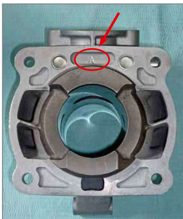
Positionierung der Kennzeichnung der Klasse auf dem Zylinder.
