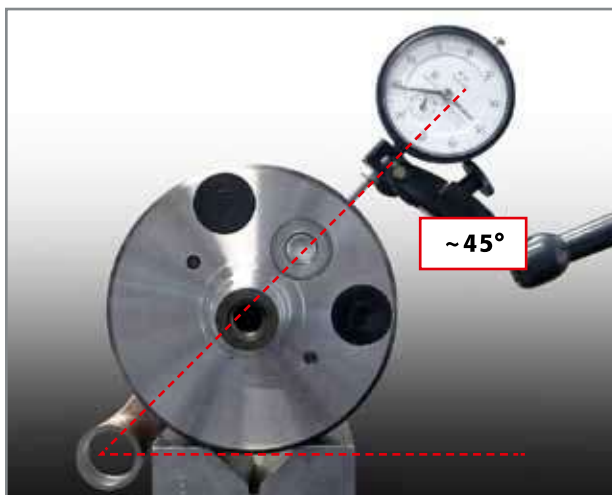
Prüfung des Radialspiels.
