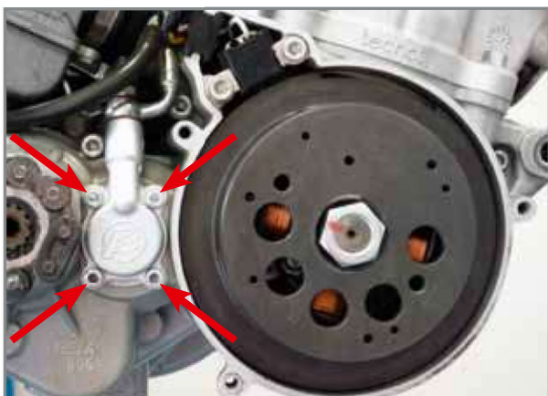
Die vier Schrauben des Kupplungsgebers.
