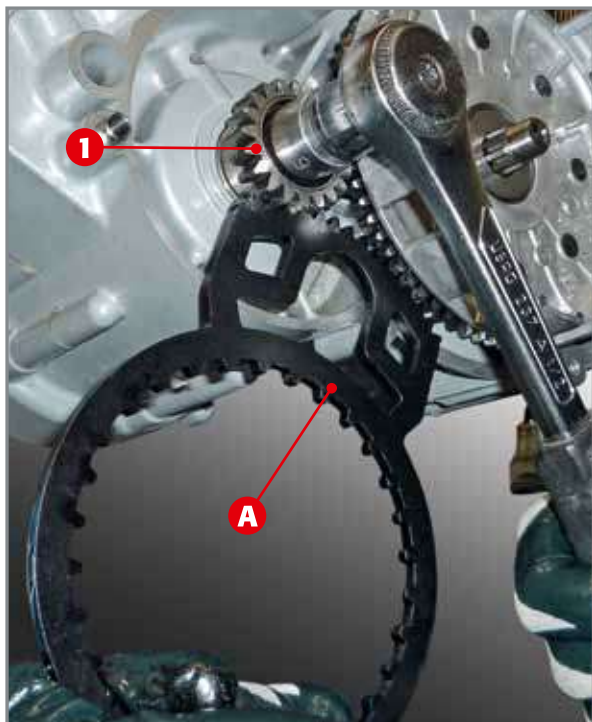
Entfernen der Schraube, die das Hauptzahnrad blockiert an die Kurbelwelle.
