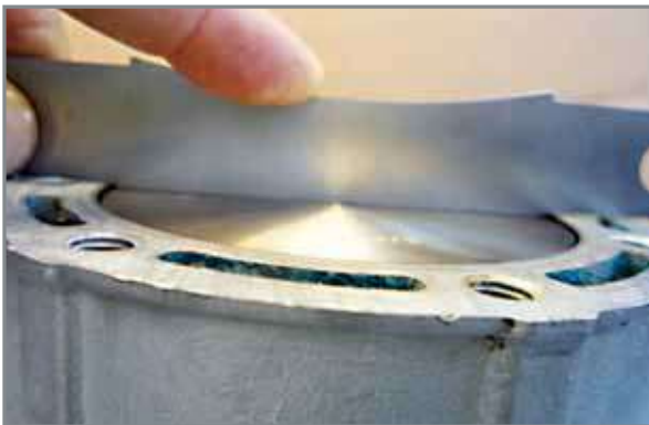
Beispiel, bei dem der Kolben die Einstelllehre berührt (Idealfall).
