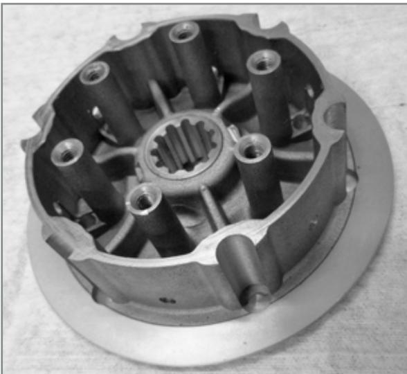
Sicherstellen, dass der mit den Scheiben in Kontakt stehende Bereich keine Kratzer, Festfressen oder ungewöhnliche Abnutzung aufweist. Im bejahenden Fall ist die Kupplungstrommel zu ersetzen. Außerdem überprüfen, dass die radialen Öffnungen an der Kupplungstrommel frei von Ablagerungen sind.
