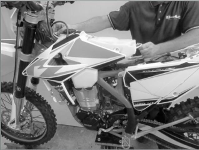
Den Tank in seinen Sitz einführen und sicherstellen, dass das Gaskabel zwischen Tank und Rahmen angeordnet ist.
