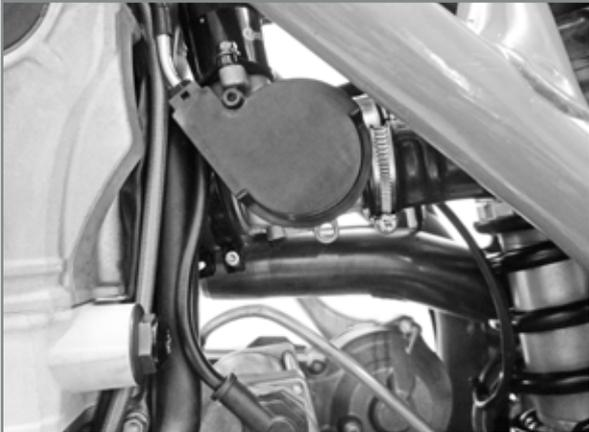
Den Deckel des Drosselklappenstutzens und die entsprechende Schraube anbringen. Schließen Sie die Stopp-Verbinder an.
