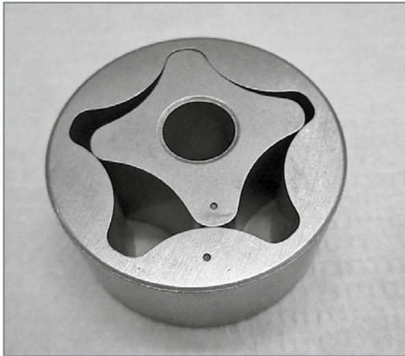
**Ölabsaugpumpe:** den Punkt auf den beiden Rotoren beachten. Der Punkt muss zur Innenseite des Motors zeigen.
