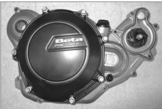
Innerer Kupplungsdeckel mit Wasserpumpe
