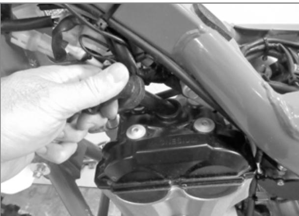
Kappe der Zündkerze trennen. Alle Bandschellen durchschneiden, mit denen die elektrische Anlage des Motors an der Kupplungsleitung und am Rahmen befestigt sind.
