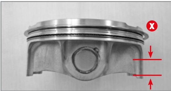
Maße zur Messung des Außendurchmessers des Kolbens.
