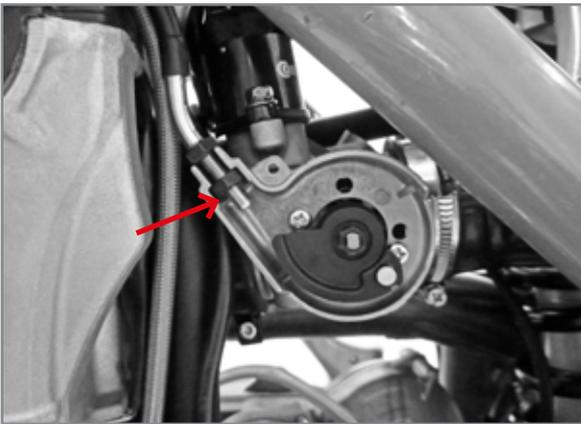
Das Gaskabel auf der linken Rahmenseite und außerhalb des Kopfanschlusses laufen lassen. Die Gaskabel am Drosselklappenstutzen anbringen und die Muttern anziehen.
