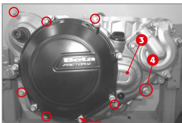
Der innere Kupplungsdeckel 3 und die entsprechenden Schrauben 4.
