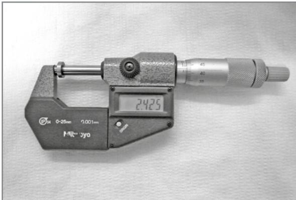
**Messungen der Passscheiben mittels Mikrometer (digital).**
