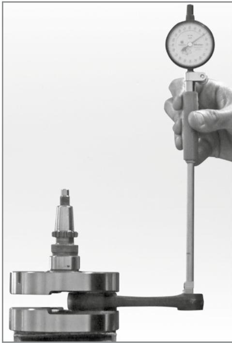
*Überprüfung des Innendurchmessers des Pleuelauges mit Bohrungsmesser.*
