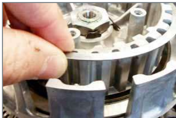
Entfernung der Spannscheibe.
