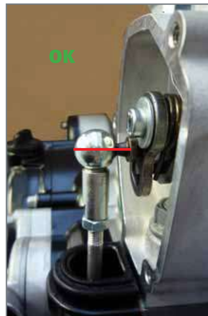
Richtige Stellung des Sitzes der Steuerstange.
