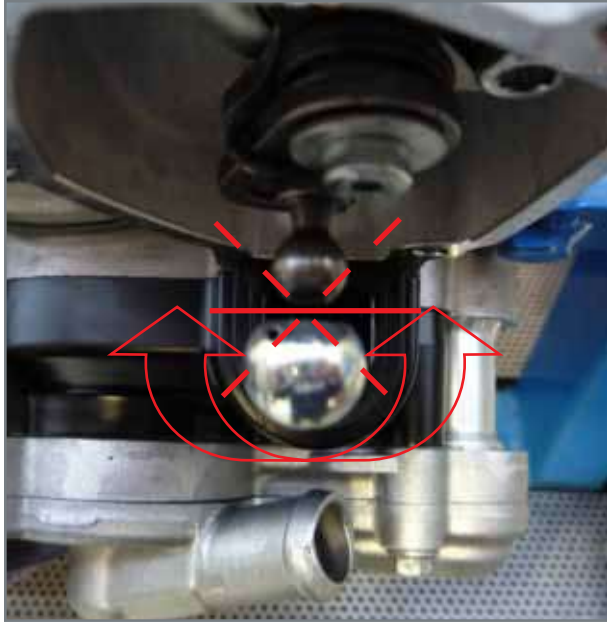
Überprüfung der Steuerstangendrehung.
