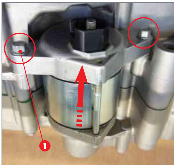
Entfernung des Anlassers.
