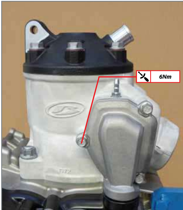
Anbringung und Anzug der Schrauben Deckel der Ventilsteuergruppe.
