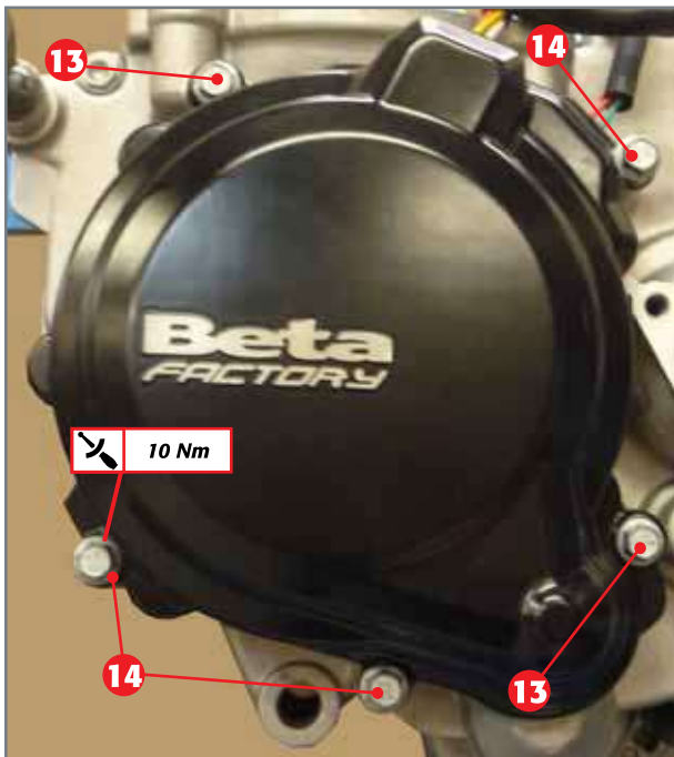
Schwungraddeckel am Gehäuse.
