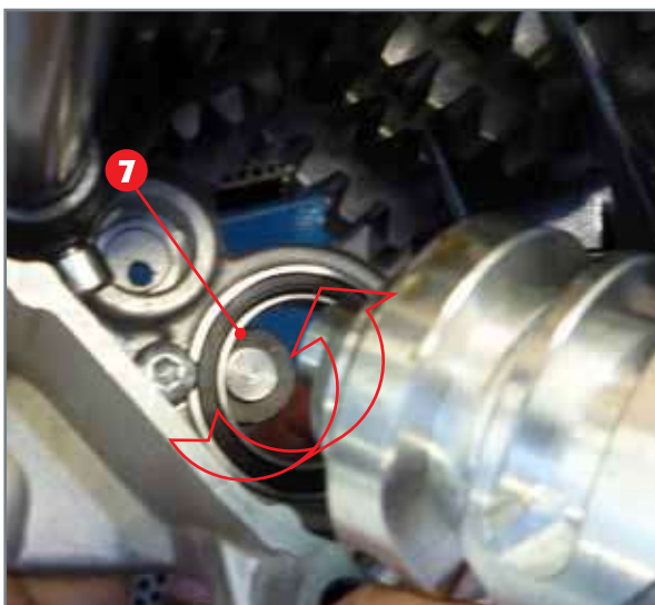
Die Zwangsteuervorrichtung in das entsprechende Lager einsetzen. Die Drehrichtung der Gangsperr beachten.
