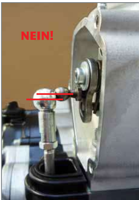
Falsche Stellung des Sitzes der Steuerstange.
