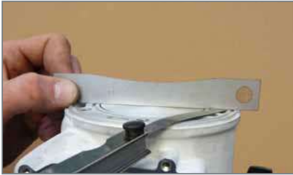
Falls der Kolben die Platte drückt und der Kontakt Zylinder Platte sich verringert.
