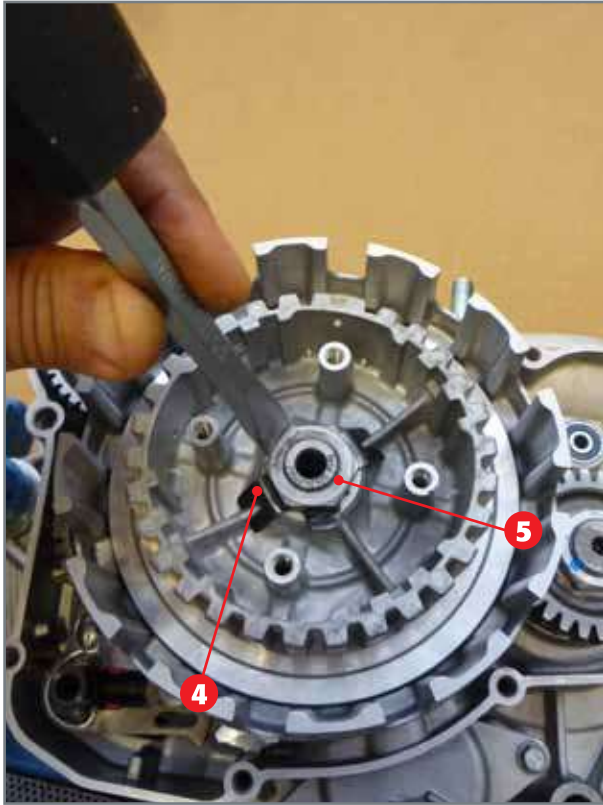
Öffnung der Sicherungsscheibe mit dem Schlitzmeißel
