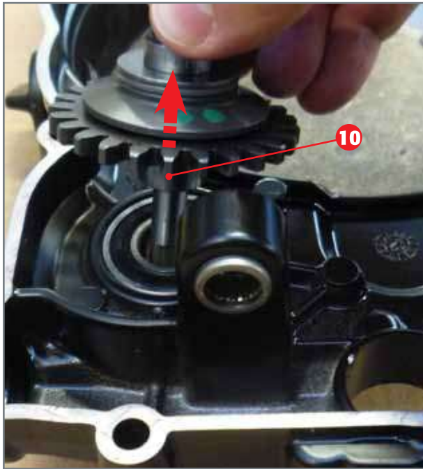
Herausziehen der Pumpenlaufradgruppe.
