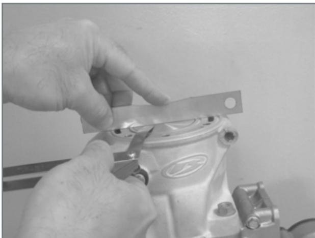
**Falls Platte und Kolben sich nicht berühren: den Abstand zwischen Platte und Kolben überprüfen.**
