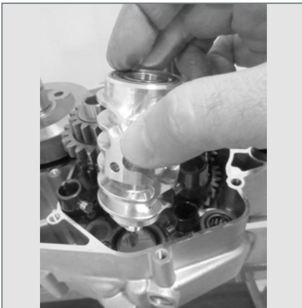
**Die Zwangsteuervorrichtung in das entsprechende Lager einsetzen.**
