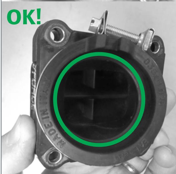
**Positionierung der Strömungsführung.**
