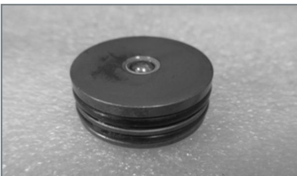
Sicherstellen, dass der Kolben intakt und frei von anormalem Verschleiß ist: Sollte dies nicht der Fall sein, den Kolben komplett mit OR auswechseln.
