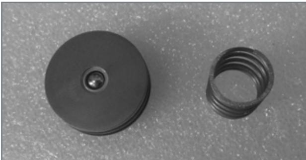
Den gesamten Kolben und die Kolbenfeder entfernen.
