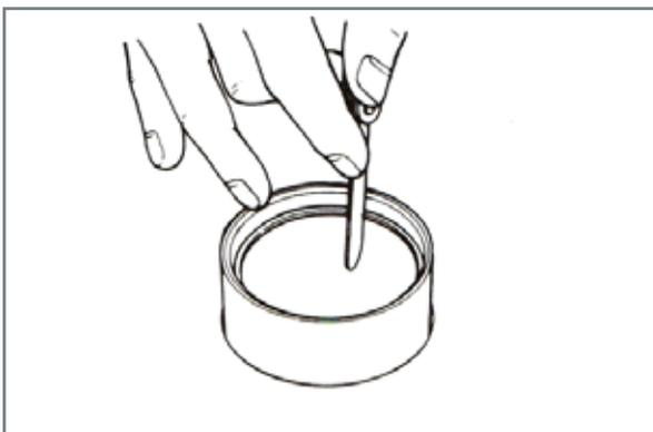
Erste Prüfung der Kolbenringe.
