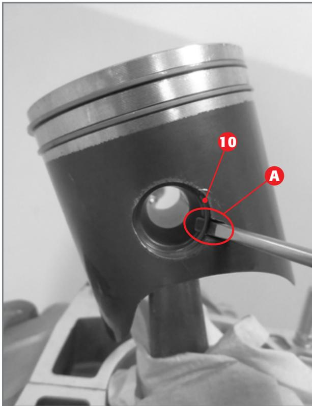
**Entfernen Seegerring Kolben**
