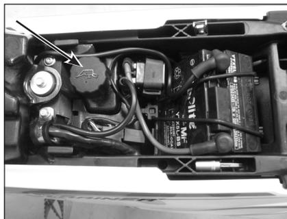
Zum Öffnen, den Tankverschluss gegen den Uhrzeigersinn drehen
