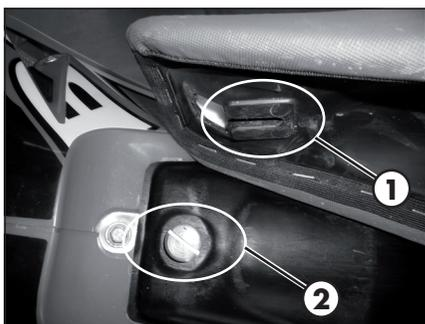
Die Schale **1** des Sattels in die Führung **2** einsetzen.
