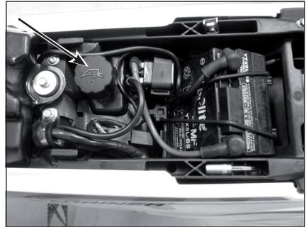
Zum Öffnen, den Tankverschluss gegen den Uhrzeigersinn drehen
