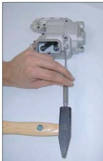
Montieren Sie den Einlasskipphebel (2) und den Auslasskipphebel (3) gemäß Abbildung und setzen Sie die zuvor gut mit Motoröl eingeölnen Anlaufscheiben 12x17x0.5 (7) zwischen die Kipphebel und den Zylinderkopfdeckel.
