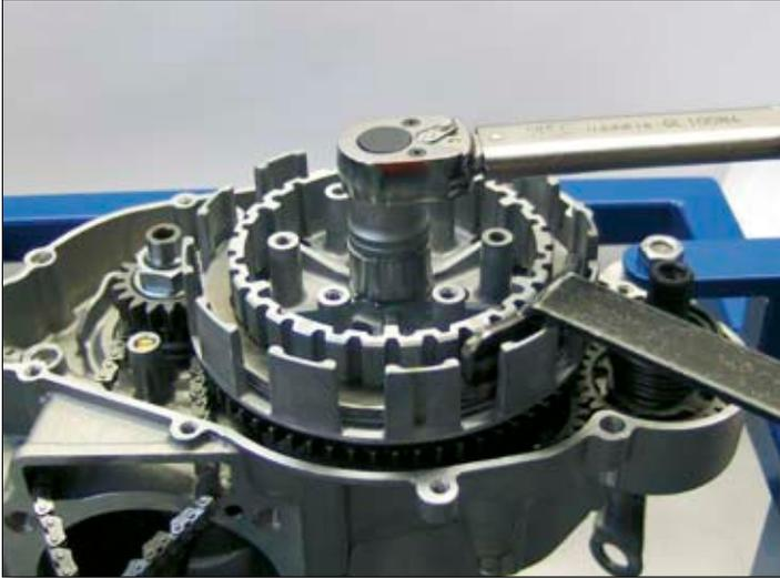
Ziehen Sie die Kupplungsnahe (11), die Anlaufscheibe (12), den Kupplungskorb (13), die Buchse (14) und die Anlaufscheibe (15) heraus.
