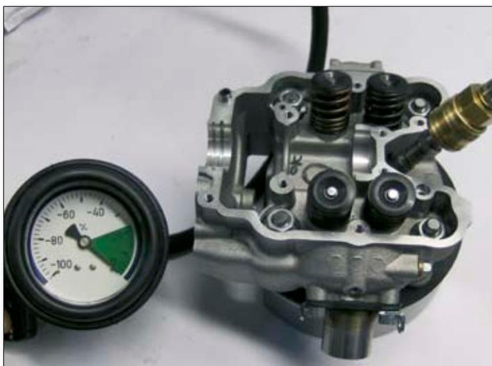
Kontrollieren Sie mit einem geeigneten Messgerät, wie gut die Ventile nach Zusammenbau des Zylinderkopfs abdichten.
