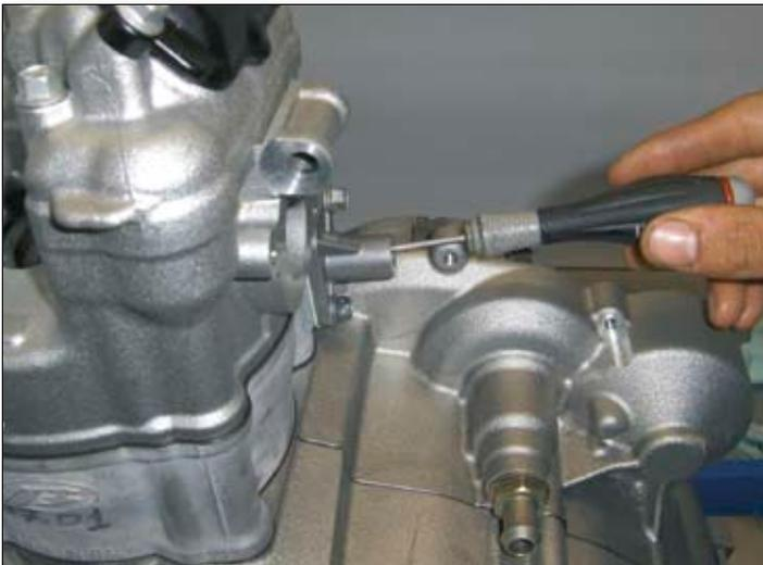
Montieren Sie den Spannerkörper und die zugehörige Dichtung und sichern Sie ihn mit M6x16-Schrauben, die Sie mit 8 Nm anziehen. Drücken Sie den Kolben mit einem Schraubendreher hinein, um die Steuerkette unter Spannung zu setzen. Setzen Sie die Feder und die Sicherungsscheibe ein, bevor Sie die Schraube festziehen.
