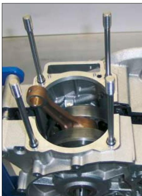
Drehen Sie den Motor so, dass die rechte Kurbelgehäusehälfte nach unten zeigt. Dann drehen Sie die Schraube am Ende des Spezialwerks so weit hinein, bis die beiden Kurbelgehäusehälften getrennt sind, wonach Sie die linke Kurbelgehäusehälfte von Hand abnehmen können.
