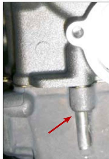
Falls die Lager der Wasserpumpenwelle ausgetauscht werden müssen, ziehen Sie das auf der Außenseite heraus, indem Sie es mit einem Stopfen zum Innern des Steuergehäuses hin schieben, bis es ganz frei ist. Für das innere Lager verwenden Sie einen Gleithammer mit passendem Innenabzieher.
