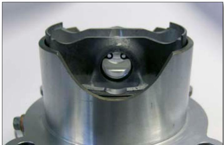
Schieben Sie den Zylinder zwischen den Stehbolzen nach unten, bis der Pleuelkopf auf einer Linie mit dem Pleuelkopflager liegt. Anschließend setzen Sie von der noch offenen Seite her den Kolbenbolzen ein und fixieren ihn mit dem entsprechenden Sicherungsring, nachdem sie zuvor die Oberflächen von Kolbenbolzen und Kolbenbolzenlager eingeölt haben.
