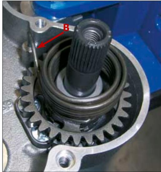
Montieren Sie das Kickstarter-Zwischenrad (17) mit den beiden Anlaufscheiben 18x27x0.5 (16, 18) auf der dafür vorgesehenen Welle, nachdem Sie die miteinander in Kontakt kommenden Teile geschmiert haben, und sichern Sie das Rad mit dem Sicherungsring (19). Vergewissern Sie sich, dass die konvexe Seite des Zahnrad zum Kurbelgehäuse zeigt. Kontrollieren Sie die korrekte Bewegung der Teile zueinander.
