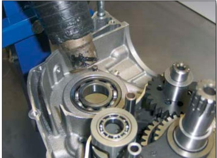
Stecken Sie die Passstifte in die entsprechenden Löcher (A).
