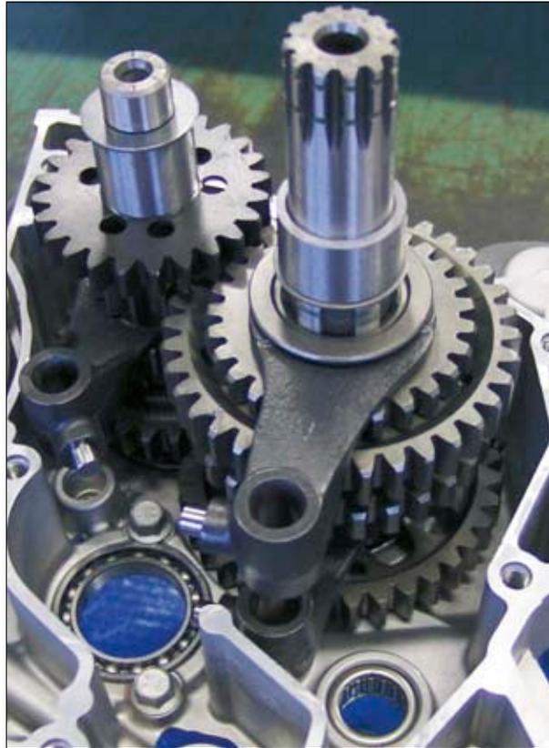
Kontrollieren Sie die Führungen in der Schaltwalze auf Verschleiß. Positionieren Sie die Walze in ihrem Lager und die Stifte in den Führungen. Drücken Sie die beiden Wellen durch die Schaltgabeln; achten Sie dabei darauf, die längere Welle für die Gabel auf der Nebenwelle zu verwenden.
