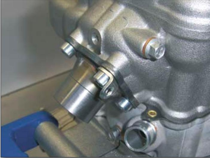
Befestigen Sie den Abgasflansch (12) mit vier M6x15-Schrauben (14) und ziehen Sie diese mit 10 Nm an. Unterlegen Sie die Schraubenköpfe mit den beiden Plättchen (13) zur Befestigung der Haltefedern für den Abgaskrümmmer. Diese Plättchen werden an der Schraube rechts oben und an der Schraube links unten angebracht, wenn man den Motor von vorne (Auslassseite) betrachtet.
