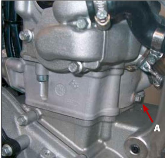
Wanne unter den Motor schieben und Ablassschraube Kuehlsystem (A) oeffnen.
