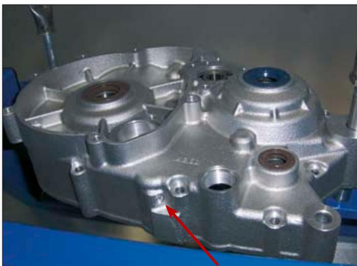
Setzen Sie den Öl-Expansionsstopfen ein und treiben Sie ihn mit einem geeigneten Splinttreiber bis zum Anschlag.
