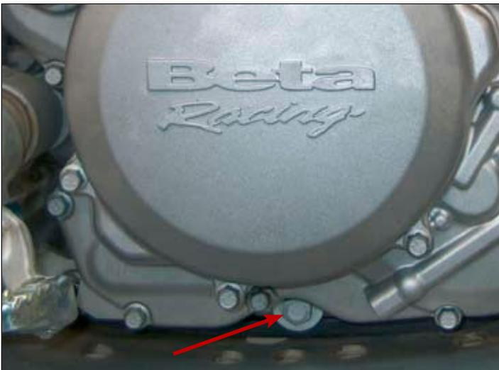
Führen Sie dieselben Arbeitsschritte auch mit dem druckseitigen Ölsieb durch, das von der rechten Gehäuseseite zugänglich ist.
