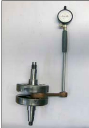
Messen Sie den Innendurchmesser der Pleuelkopfbuchse und bestimmen Sie dann das Spiel mit dem Kolbenbolzen. Wenn dieses Spiel - bei Kolbenbolzendurchmesser innerhalb der vorgeschriebenen Grenzen - den zulässigen Wert überschreitet, muss das Pleuel ersetzt werden.
