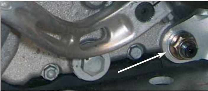
Mutter der unteren Motorhalterung loesen. Bolzen nicht ausziehen.
