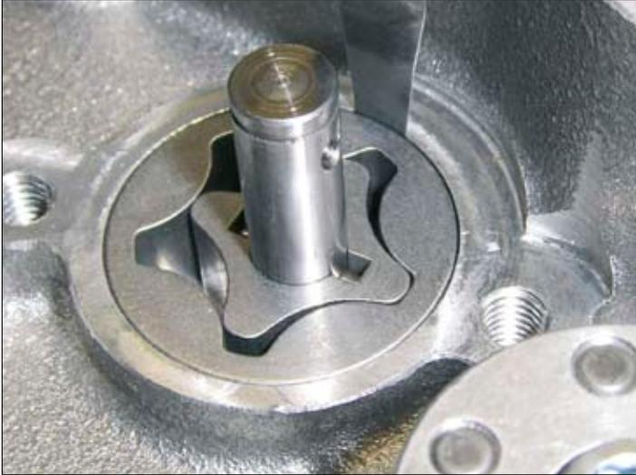
Messen Sie, ebenfalls mit einer Fühlerlehre, auch den Abstand zwischen Außenrotor und Pumpenaufnahme.
