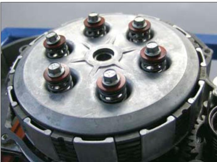
Montieren Sie die Kupplungsdruckplatte (13), die Kupplungsfedern (14), die speziellen Sicherungsscheiben (15) und die Schrauben M6x16 (16).
