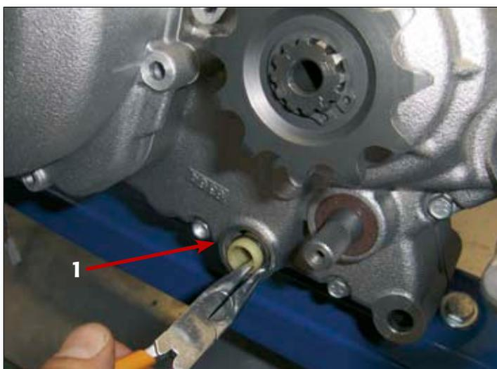
Nehmen Sie die Ölfilter auf linken (1) und rechten (2) Kurbelgehäusehälfte heraus, nachdem Sie zunächst die Filterdeckel entfernt haben.
