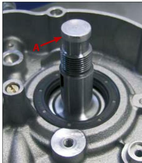
Montieren Sie den Abdrücker an der rechten Kurbelgehäusehälfte, indem Sie ihn in den Gewindebohrungen für die Schrauben des Kupplungsgehäuses befestigen. Dann schrauben Sie die Schraube am Ende des Spezialwerkzeugs so weit hinein, bis die Kurbelwelle abgezogen ist.
