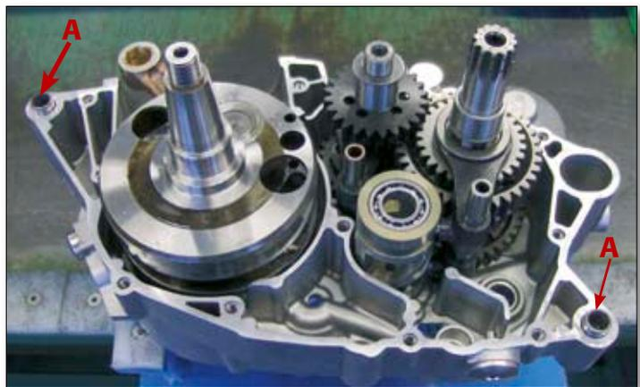
Fetten Sie den Kurbelwellenabschnitt ein, der in den Wellendichtring in der linken Kurbelgehäusehälfte (1) geschoben werden soll, und setzen Sie die Kurbelgehäusedichtung ein, wobei Sie diese im Zylinderbereich (2) durchschneiden, damit sie beim Zusammenbau nicht dem Pleuel im Wege ist.
