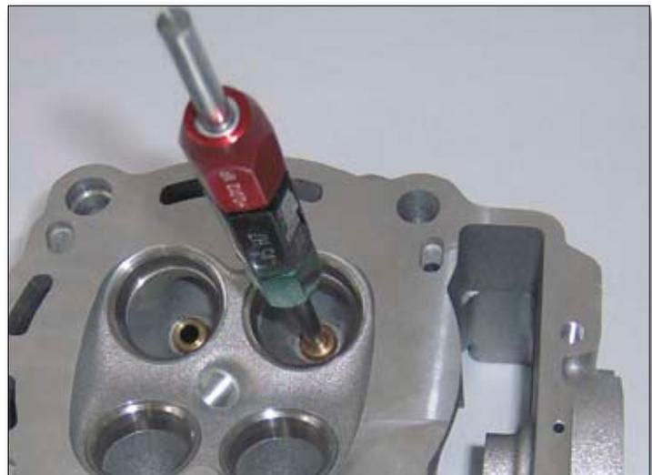
Kontrollieren Sie das Spiel zwischen Ventilschaft und Ventileführung. Hierzu setzt man das Ventil so in die Ventileführung, dass das obere Ende des Ventilschafts bündig mit der Führung abschließt und misst dann das maximale Radialspiel des Ventiltellers.
