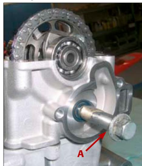
Demontieren Sie den Steuerkettenspanner, indem Sie die beiden Befestigungsschrauben lösen. Entfernen Sie die Nockenwelle und die Nockenwellenlager vom Zylinderkopf; achten Sie dabei darauf, dass die Steuerkette nicht ins Steuergehäuse fällt. Zur Inspektion und zum Zerlegen der Nockenwelle siehe die Angaben im Kapitel Zusammenbau.
