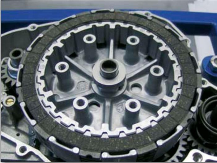
Nachdem Sie alle Kupplungslamellen montiert haben, setzen Sie den Ausrückbolzen (10) zusammen mit dem Nadellager (11) und der entsprechenden Sicherungsscheibe (12) in die zentrale Bohrung im Kupplungskorb. Kontrollieren Sie das Nadellager und die Kontaktflächen auf Verschleiß. Bei übermäßigem Verschleiß sind die Teile zu ersetzen.
