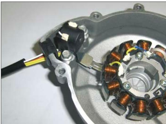
Befestigen Sie den Stator (3) mit drei M5x25-Schrauben (4) an der Schwungradabdeckung (2). Ziehen Sie die Schrauben mit 6 Nm an. Achten Sie darauf, dass die Führungsplatte für das Statorkabel zum Innern der Abdeckung zeigt.
