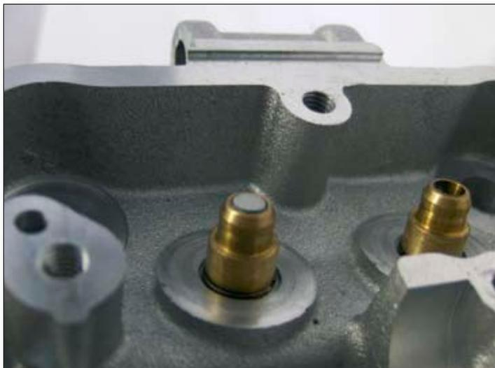
Kontrollieren Sie den Verschleißzustand und die Dichtfläche der Ventilsitze. Hierzu wird eine dünne Schicht Preußischblau auf die Kontaktfläche des Ventils mit dem Ventilsitz aufgetragen. Anschließend schiebt man das Ventil in die Ventilführung, bis es gegen den Ventilsitz drückt, und dreht es dann um die eigene Achse. Wenn das Ventil wieder herausgezogen wird, fehlt auf der Kontaktfläche die Farbe. Die Breite dieser Kontaktfläche muss bestimmte Grenzwerte einhalten:
