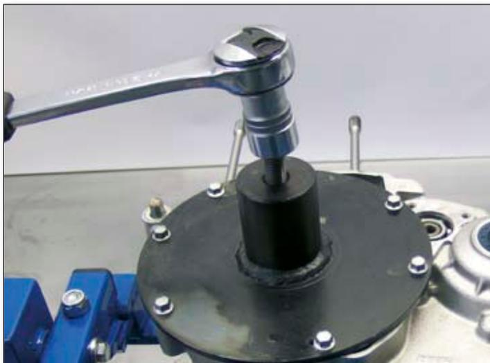
Sobald Sie die Zylinderfußdichtung entfernt haben, können Sie zum Öffnen des Kurbelgehäuses das dafür vorgesehene Spezialwerkzeug verwenden, das Sie auf der linken Kurbelgehäusehälfte in die Gewindebohrungen für die Befestigungsschrauben der Schwungradabdeckung einschrauben.
