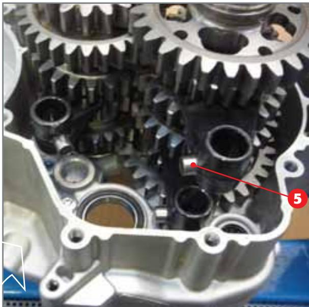
Entfernung der Schaltgabeln aus dem Schaltaggregat.
