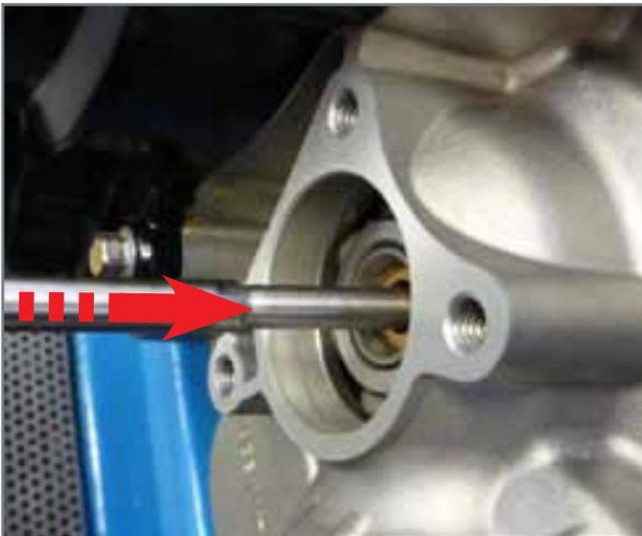
**Einsetzen der Kupplungsstange.**
