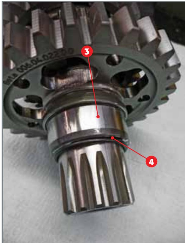
*Detailansicht der Büchse 3 und des O-Rings 4, die mit der Nebenwelle verbunden sind.*
