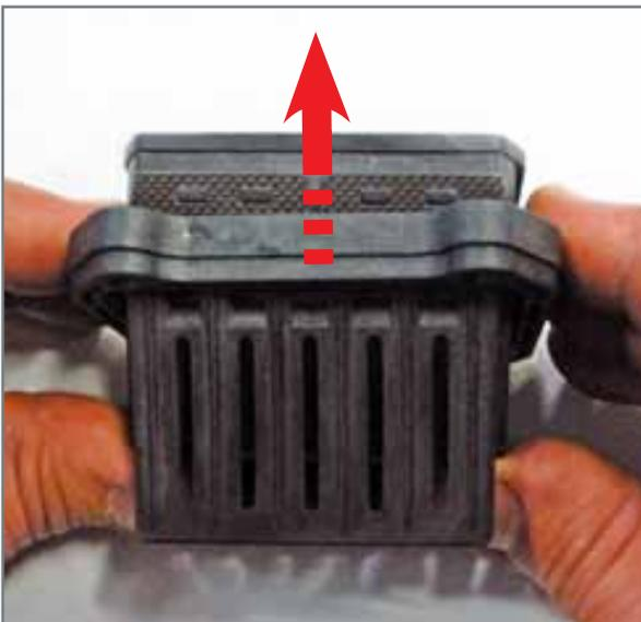
**Abbau des Körpers des Lamellenpakets.**
