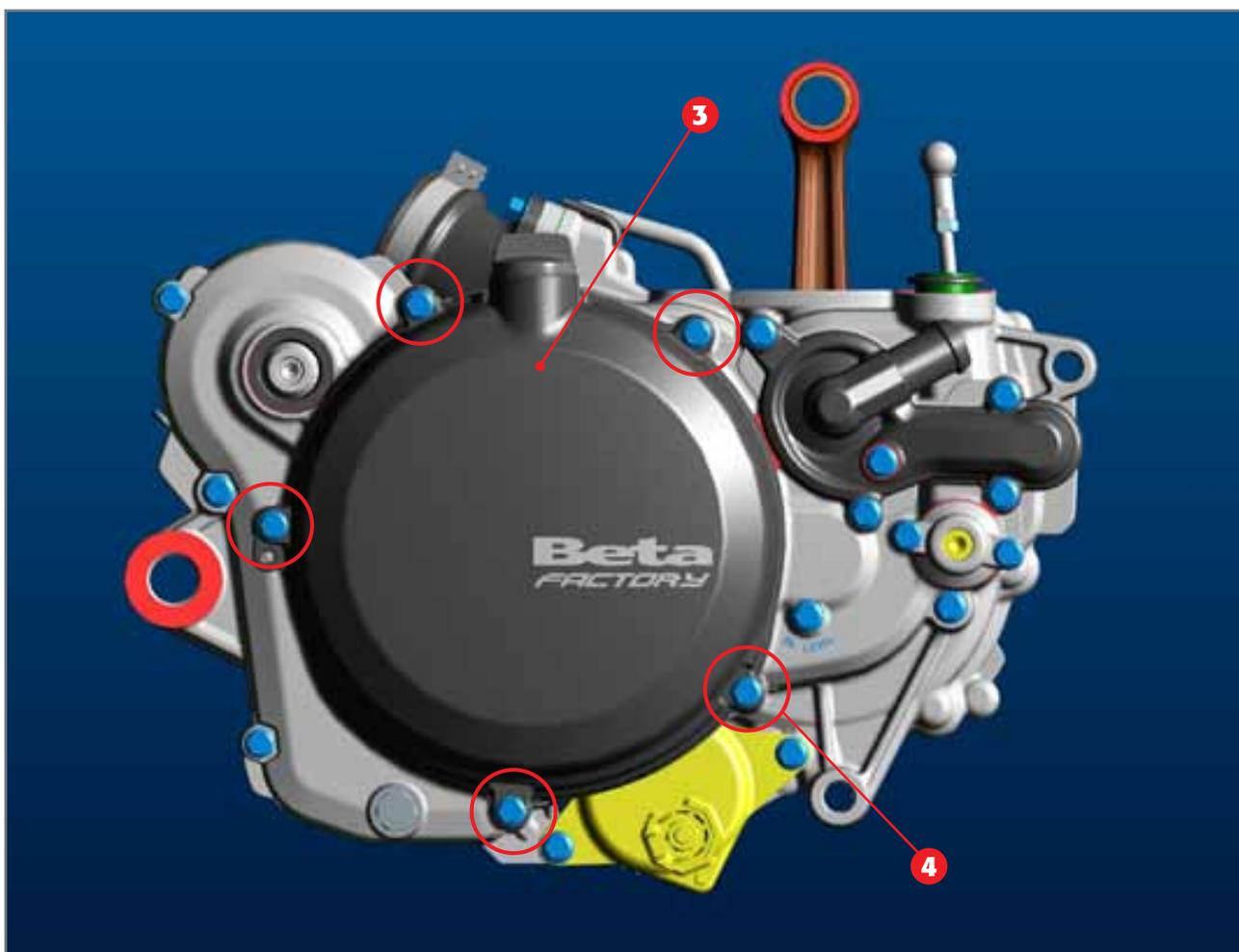
*Schrauben äußerer Kupplungsdeckel.*
