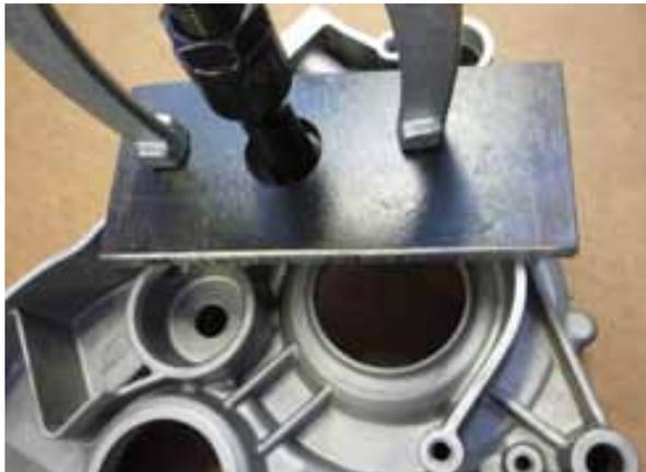
Die Entfernung des Lager der Pumpenlaufadwelle kann über die Verwendung eines Universalabziehers erfolgen, der auf eine eigens vorbereitete Metallplatte aufsetzt.
