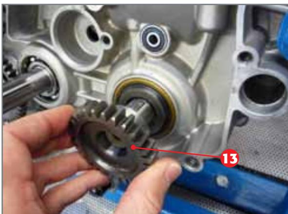
Entfernung des Primärgetriebes,
