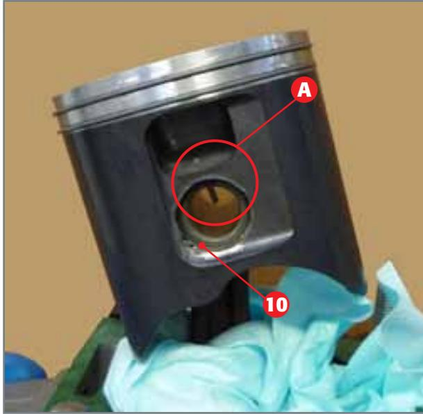
Entfernen Seegerring Kolben.
