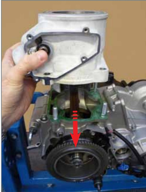
*Kupplung Zylinder an Kolben und Gehäuse.*
