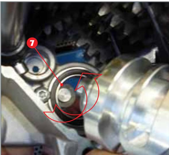
Die Zwangsteuervorrichtung in das entsprechende Lager einsetzen. Die Drehrichtung der Gangsperre beachten.
