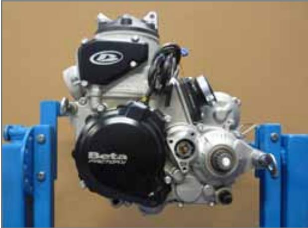
Verbindung des Motors mit dem spezifischen Stützständer *Cod. 3625132000* über die vordere Befestigung *Cod. 026140030 000*, damit bequem und sicher gearbeitet werden kann. Dann wie im Folgenden beschrieben vorgehen
