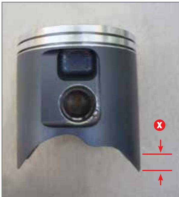
Maße zur Messung des Außendurchmessers des Kolbens.
