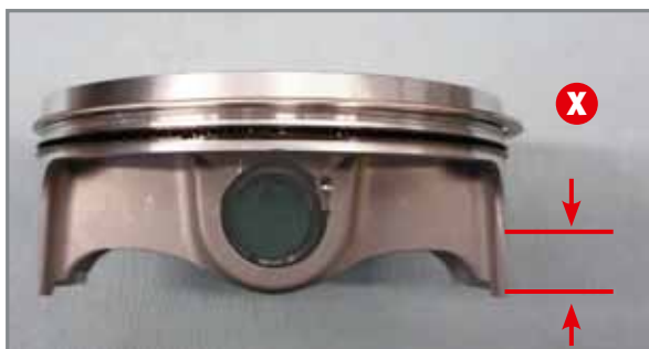
Höhe an welcher der Kolbendurchmesser gemessen wird.
