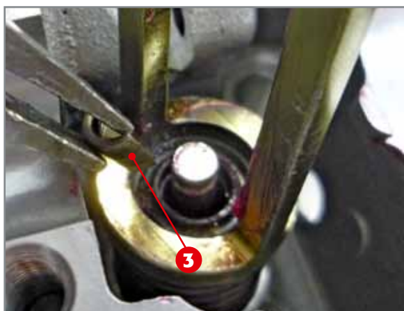
Zusammendrücken der Feder, Einsetzen der Ventilfeederkeile. Auftragen des Fettes auf dem oberen Teils des Schafts.
