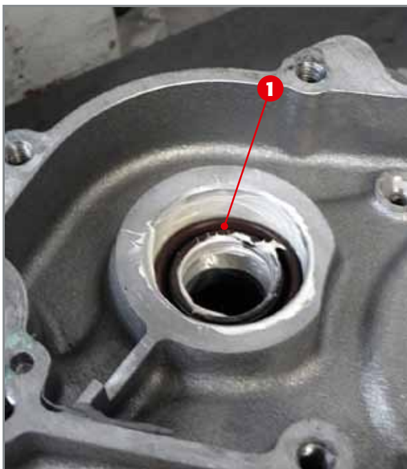
Anbringen des Wellendichtringes 1.
