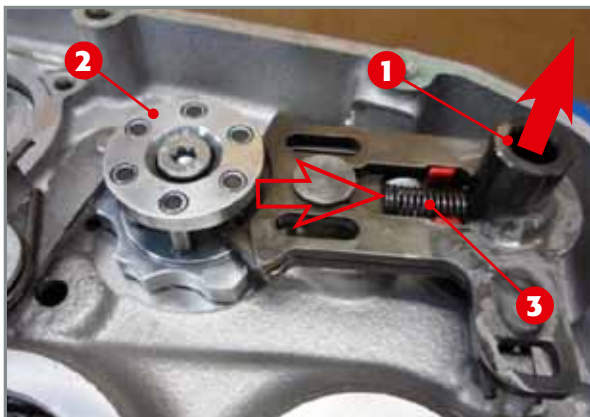
Entfernung der Schaltwelle.
