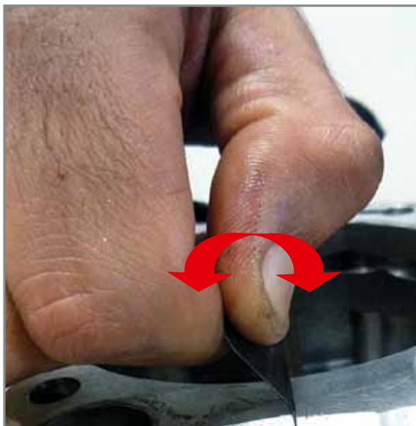
Abtrennen der überstehenden Dichtung zwischen den Motorgehäusehälften.
