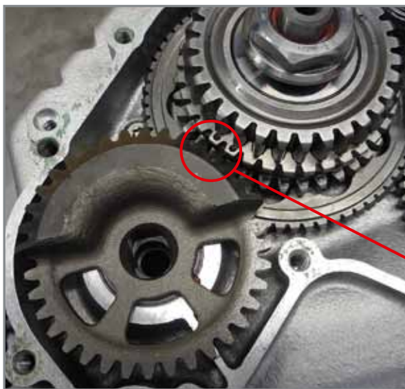
Einbau der Ausgleichswelle.
