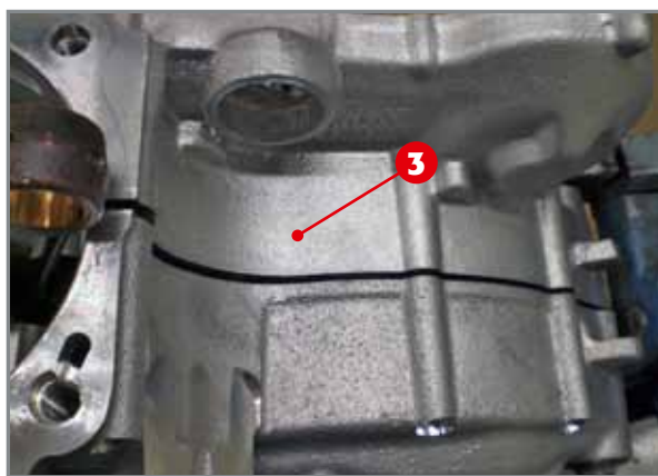
Lösen der Gehäusehälfte.
