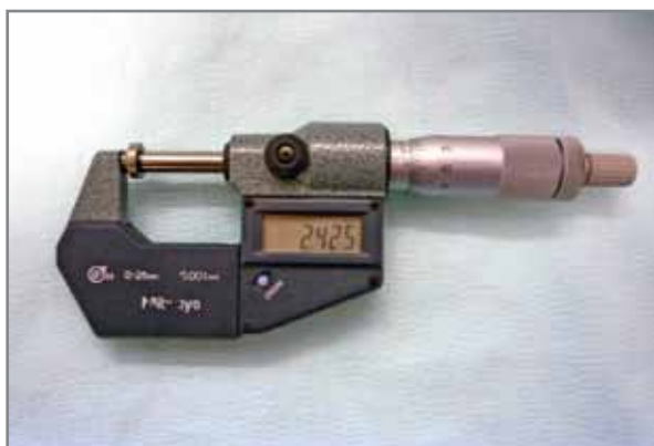
Die Shimstaerke mit dem Mikrometer ermitteln.
