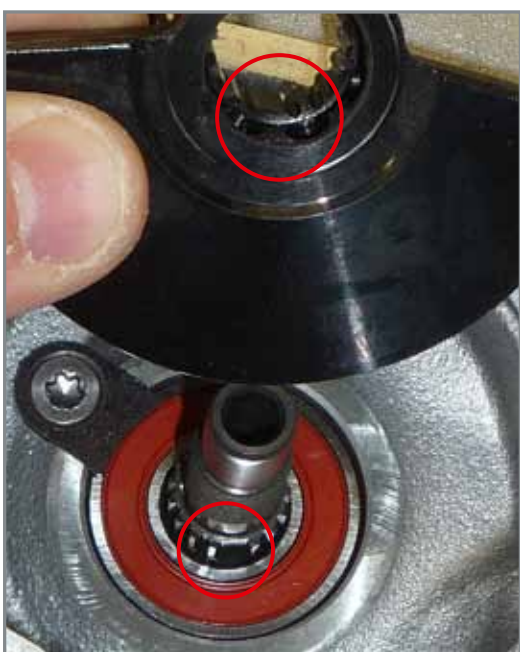
Detailansicht der Verzahnungsprofile für die Verbindung
