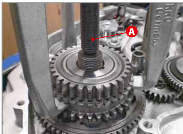
Entfernung des Primärrads mit entsprechendem Abzieher A.
