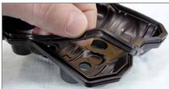
Einsetzen der Dichtung in die Nut am Ventildeckel
