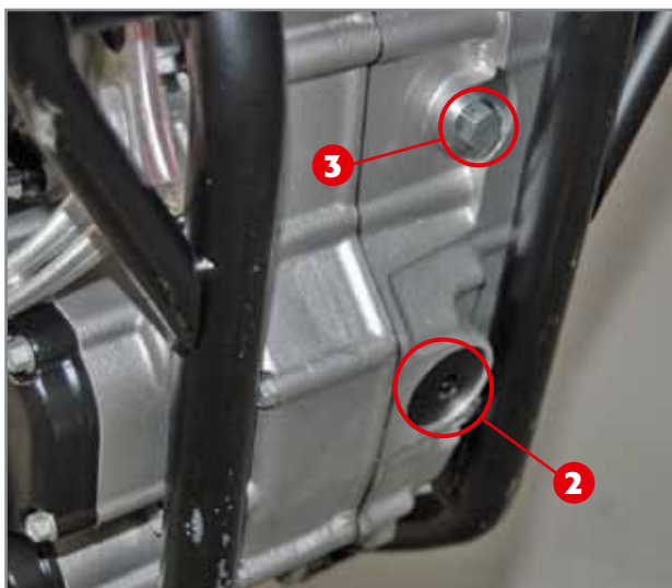
Ölablassschraube 2 des Motors und Ölablassschraube 3 des Getriebes.
