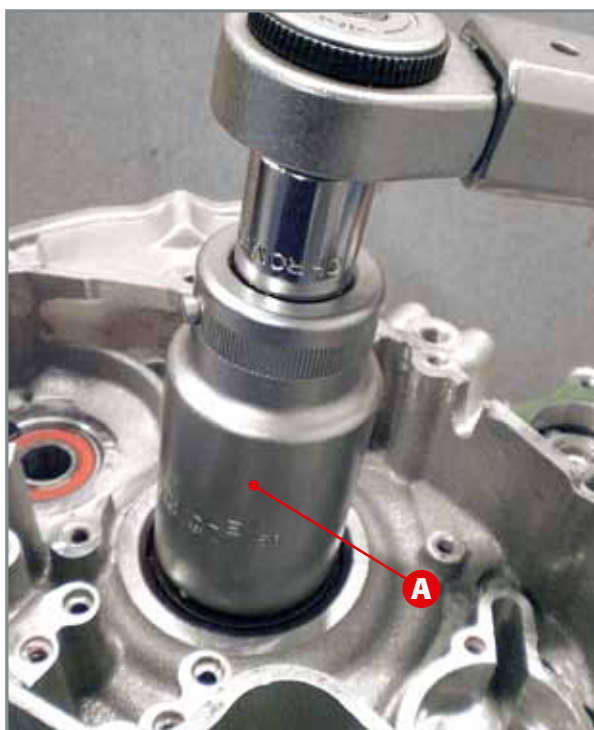
Entfernung Mutter der Kurbelwelle mit Spezial-Steckschlüssel A.
