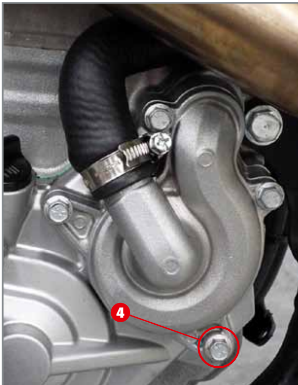
Ölablassschraube 4 der Kühlflüssigkeit.
