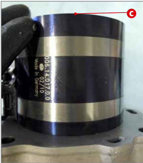
Anbringung des Rings mit Kolben am Zylinder.
