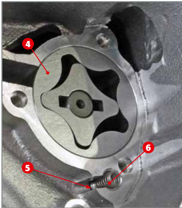
Absaugpumpe mit Gehäusehälfte.
