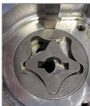
Bewertung des Radialspiels zwischen Außenrotor und Gehäuse.
