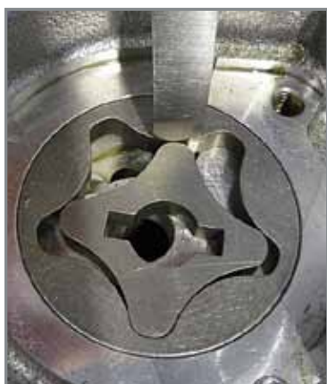
Bewertung des Radialspiels zwischen Innen- und Außenrotor.
