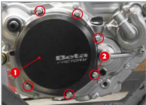
Der äußere Kupplungsdeckel 1 und die entsprechenden Schrauben 2.
