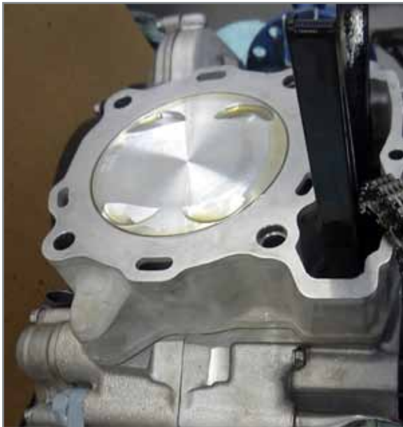
Verbindung des Zylinders am Gehäuse.
