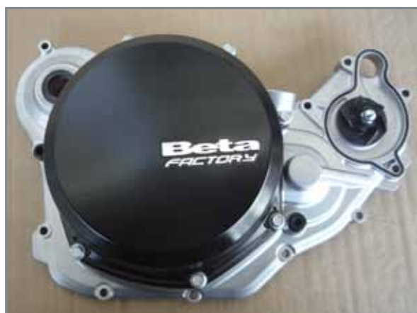
Innerer Kupplungsdeckel mit Wasserpumpe.
