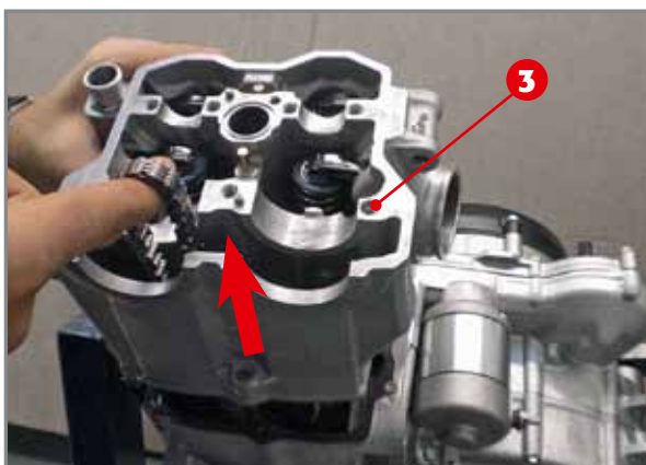
Entfernung des Zylinderkopfes.
