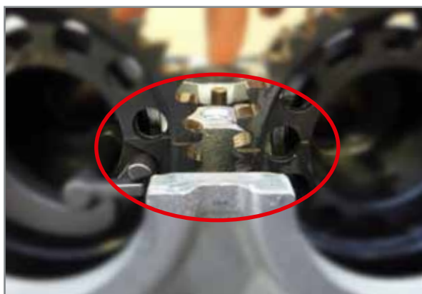
Detailansicht der korrekten Ausrichtung der eingravierten Markierungen an den Zahnradern der Nockenwellen.
