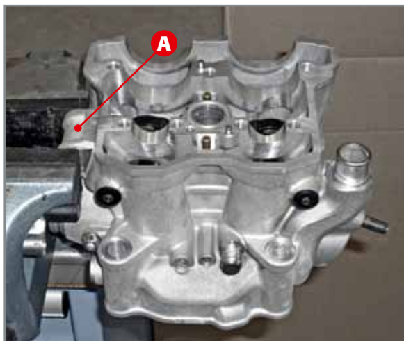
Blockieren des Zylinderkopfes im Schraubstock.
