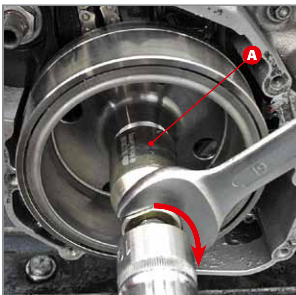
Entfernung des Schwungrads der Zündung mit entsprechendem Abzieher A.
