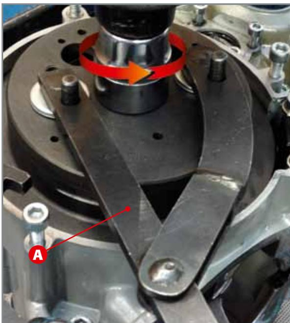
*Blockierung des Schwungrads mit Hilfe eines Universalwerkzeugs.*
