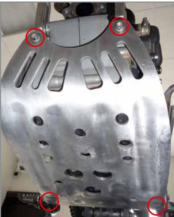
Die vier Schrauben der Motorschutzplatte.
