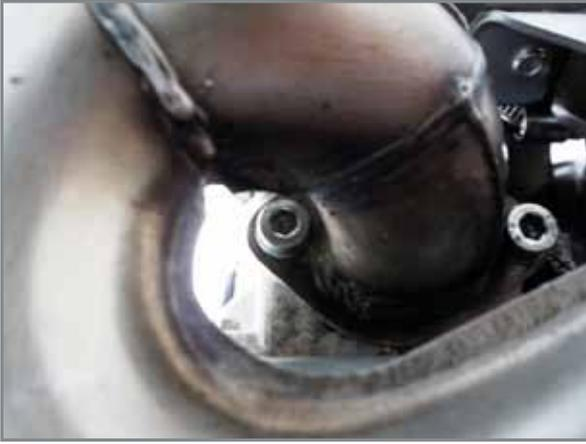
Die beiden Flanschschrauben Abgaskrümmer.
