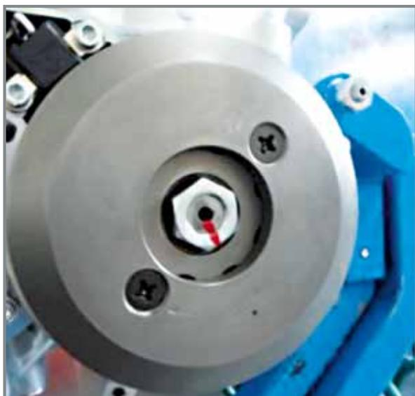
**Anmerkung:** Die Version GB besitzt ein zusätzliches Gewicht, das vor der Demontage des Schwungrads entfernt werden muss. Dazu müssen die beiden Schrauben erhitzt und entfernt werden.
