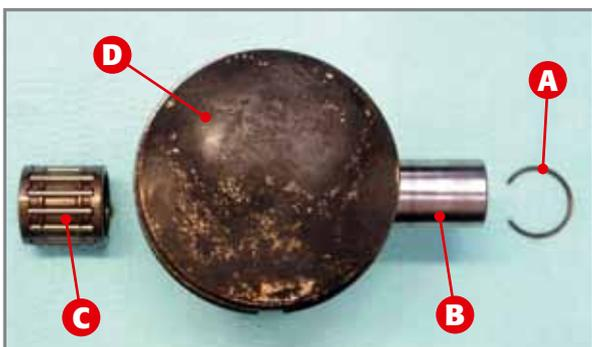
Kompletter Kolben. A) Bolzenfeststellring; B) Zapfen; C) Lagerkäfig; D) Kolben.
