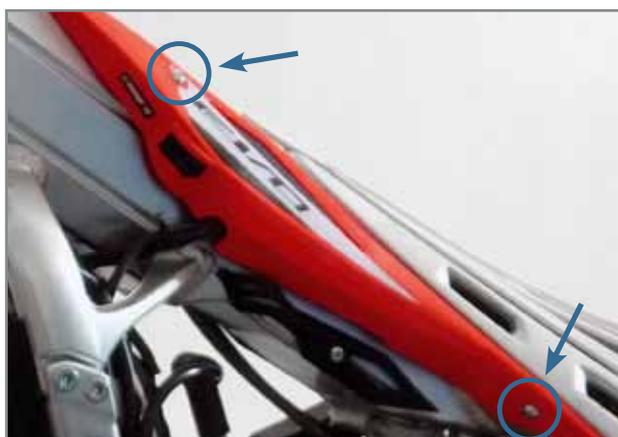
**Schrauben, mit denen der linke Seitendeckel am Tank fixiert ist.**
