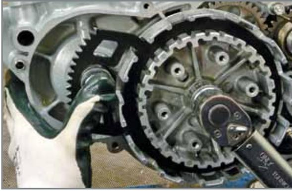
Anzug der Mutter, mit der die Kupplungstrommel an die Hauptwelle fixiert wird.
