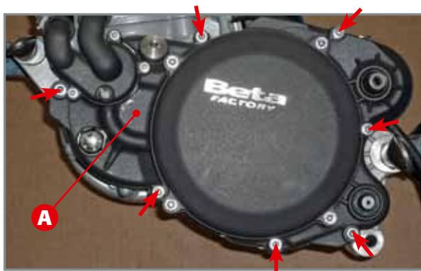
Die sieben Schrauben, mit denen die Innenabdeckung der Kupplung an das Gehäuse gekoppelt ist.
