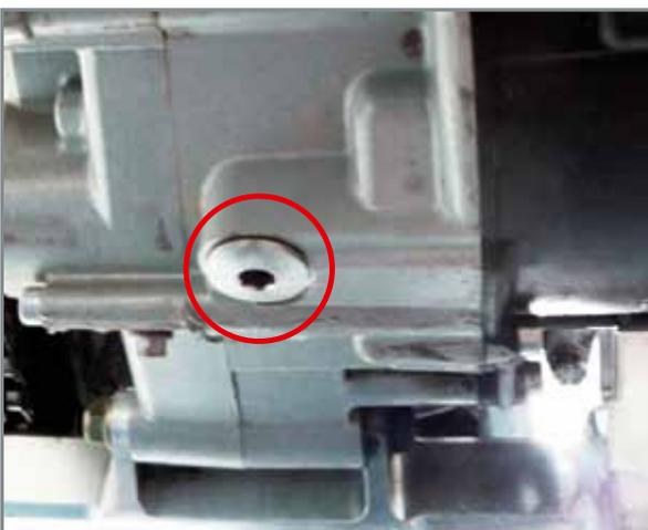
Der Verschluss für den Auslass des Getriebeöls
