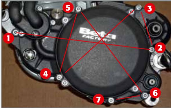
Anordnung der Schrauben auf dem internen Kupplungsdeckel.
