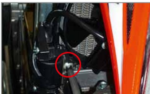
**Schraube, mit der die Spulenhalterung am Kühler befestigt ist.**
