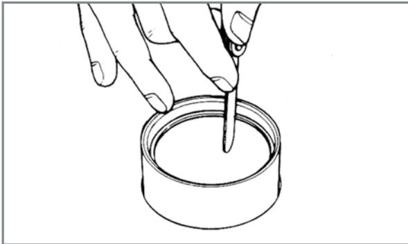
Erste Prüfung der Kolbenringe.
