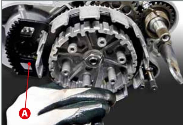
**Öffnen der Federkeile der Sicherungsscheibe.**
