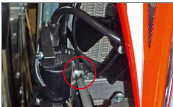
Rimontaggio bobina e supporto.
