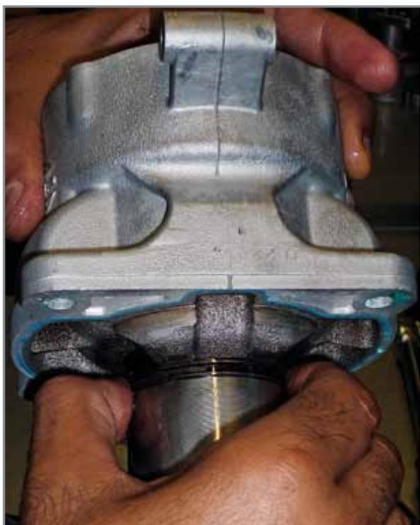
Einsetzen des Kolbens in den Zylinder.
