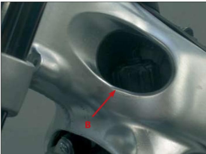
Öffnen Sie dann den Kühlerdeckel (B), damit die gesamte Flüssigkeit aus dem System abfließen kann.
