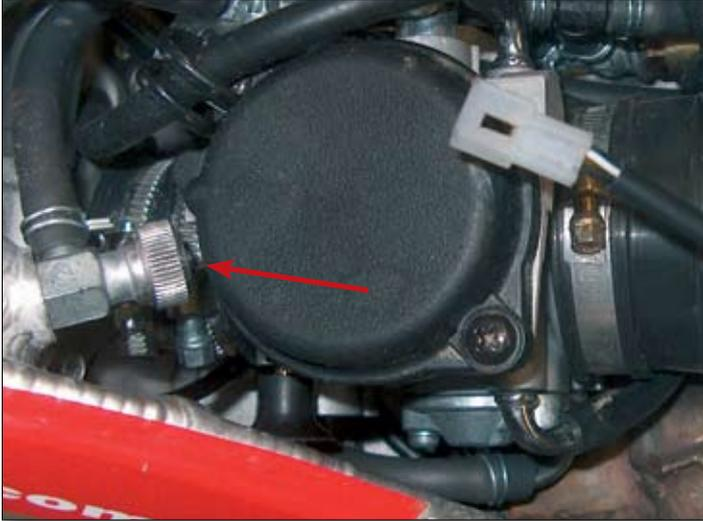
Schließen Sie den Hahn am Benzintank, indem Sie den entsprechenden Drehknopf hineinschrauben.
