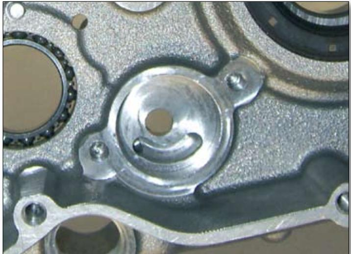
Montieren Sie den Kurbelwellendichtring (12), indem Sie ihn außen einfetten, damit er leichter einzusetzen ist. Drücken Sie ihn, mit der offenen Seite nach innen, in den Sitz, bis er bündig abschließt.
