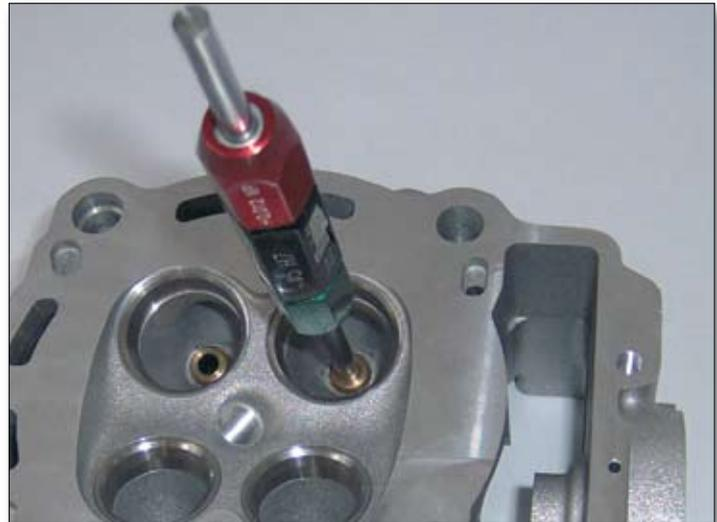
Kontrollieren Sie das Spiel zwischen Ventilschaft und Ventilfehrung. Hierzu setzt man das Ventil so in die Ventilfehrung, dass das obere Ende des Ventilschafts bündig mit der Föhrung abschließt und misst dann das maximale Radialspiel des Ventiltellers.
