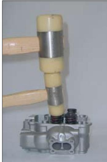
Schlagen Sie ein paar Mal mit einem doppelten Gummihammer auf die oberen Federteller, damit sich die Ventilkeile setzen.
