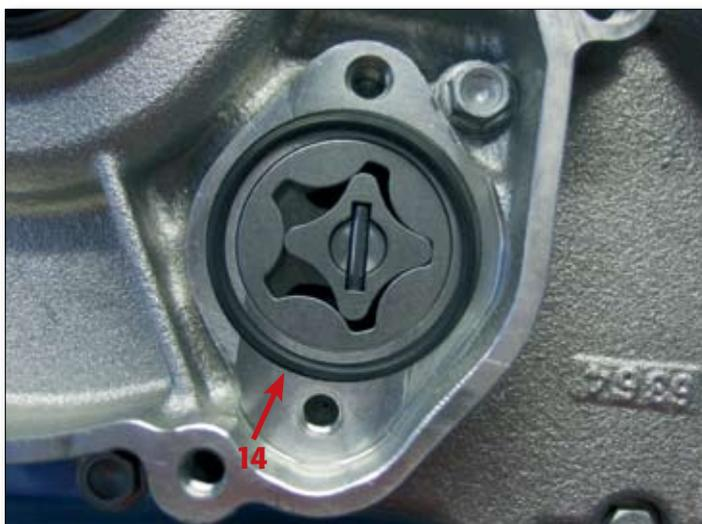
Setzen Sie den O-Ring (14) in die Nut und schließen Sie den Deckel (15) der Pumpe.
