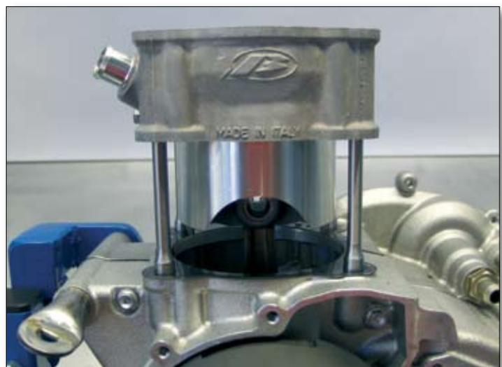
*Hinweis: Vergewissern Sie sich vor Einbau des Zylinders, dass die Zylinderfußdichtung schon eingesetzt ist.*
