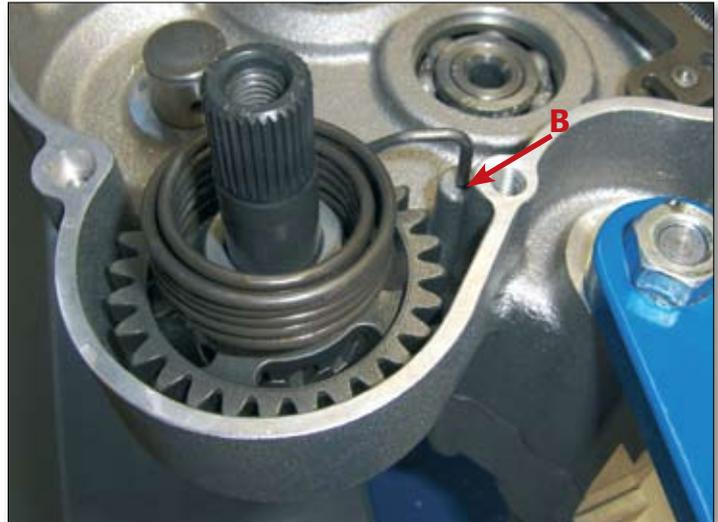
Montieren Sie das Kickstarter-Zwischenrad (17) mit den beiden Anlaufscheiben 18x27x0.5 (16, 18) auf der dafür vorgesehenen Welle, nachdem Sie die miteinander in Kontakt kommenden Teile geschmiert haben, und sichern Sie das Rad mit dem Sicherungsring (19). Vergewissern Sie sich, dass die konvexe Seite des Zahnrad zum Kurbelgehäuse zeigt. Kontrollieren Sie die korrekte Bewegung der Teile zueinander.
