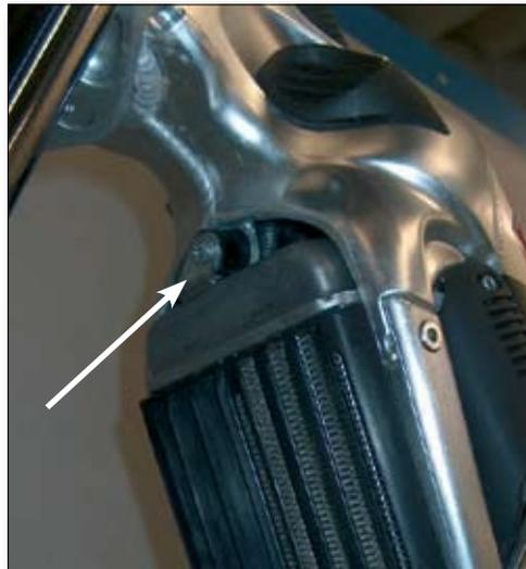
Lösen die Befestigungsschraube des Kühlers und nehmen Sie dann die ganze Baugruppe Kühler/Halterung heraus, nachdem Sie zuvor die Stecker für Elektrolüfter und Kühlersensor abgezogen haben.
