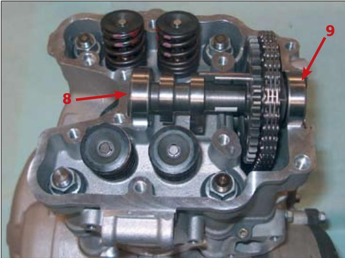
Führen Sie die Steuerkette um das Nockenwellenrad und montieren Sie dann zuerst das gedichtete Lager (8) und anschließend das kettenseitige Lager (9).
