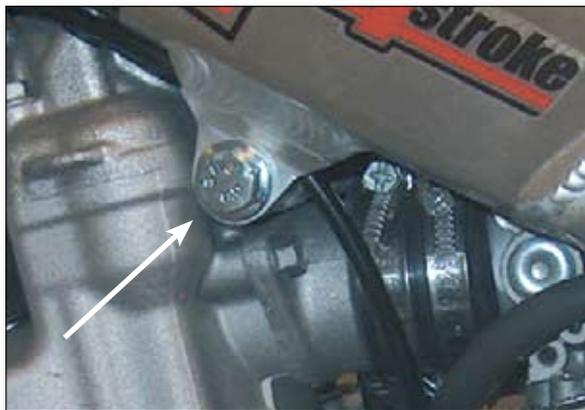
Nehmen Sie den Bolzen heraus, mit dem der Zylinderkopf am Rahmen befestigt ist.
