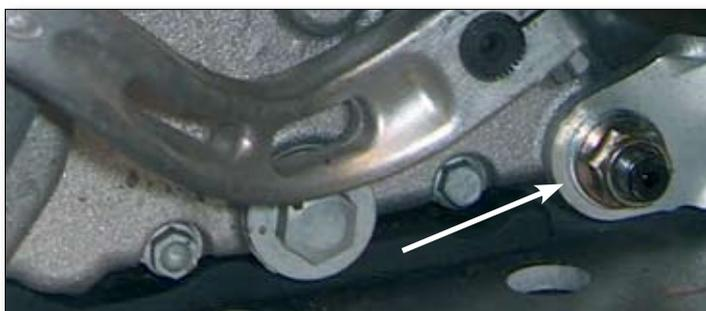
Lockern Sie die Sicherungsmutter des unteren Bolzens der Motoraufhängung.
