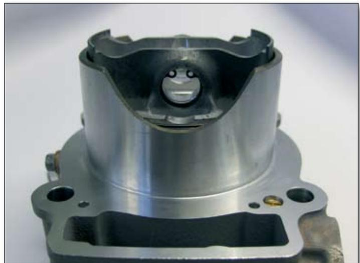
Schieben Sie den Zylinder zwischen den Stehbolzen nach unten, bis der Pleuelkopf auf einer Linie mit dem Pleuelkopflager liegt. Anschließend setzen Sie von der noch offenen Seite her den Kolbenbolzen ein und fixieren ihn mit dem entsprechenden Sicherungsring, nachdem sie zuvor die Oberflächen von Kolbenbolzen und Kolbenbolzenlager eingölt haben.
