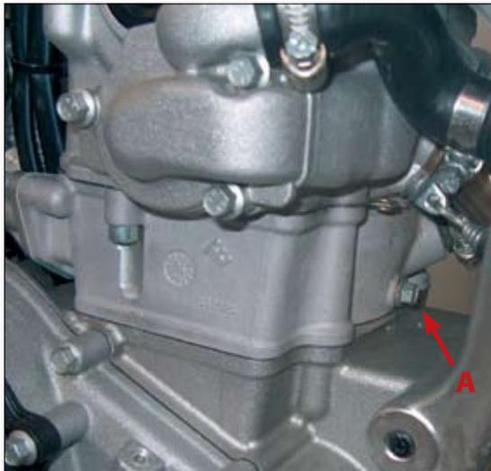
Stellen Sie eine Auffangwanne unter den Motor und lösen Sie die Ablassschraube für das Kühlsystem (A).
