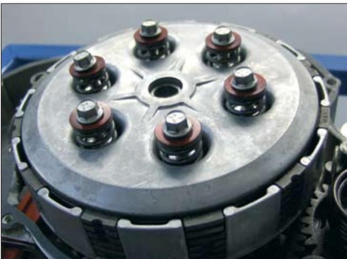
Montieren Sie die Kupplungsdruckplatte (13), die Kupplungsfedern (14), die speziellen Sicherungsscheiben (15) und die Schrauben M6x16 (16). Ziehen Sie die Schrauben (16) über Kreuz mit 10 Nm an.
