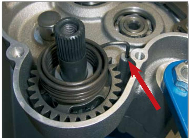
*Hinweis: Um das Herausnehmen des Anschlags zu erleichtern, können Sie ihn erwärmen, damit die Schraubensicherung auf den beiden Befestigungsschrauben wieder weich wird.*
