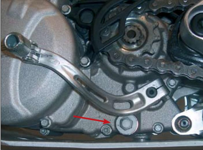
Schrauben Sie den Stopfen auf der linken Gehäuseseite heraus und ziehen Sie das Sieb mit einer Zange heraus. Reinigen Sie es gründlich und blasen Sie es mit Druckluft durch. Kontrollieren Sie die O-Ringe auf Beschädigung und ersetzen Sie sie, falls nötig. Bauen Sie alle Teile wieder ein und ziehen Sie den Stopfen mit 15 Nm an.
