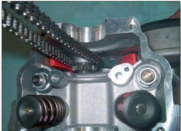
Lösen Sie die Zylinderkopfmutter, die auf die Stehbolzen geschraubt sind, sowie die Schraube auf der Wasserpumpenseite. Anschließend nehmen Sie den Zylinderkopf und die Zylinderkopfdichtung ab, wobei darauf zu achten ist, auch die Passstifte zu entfernen.
