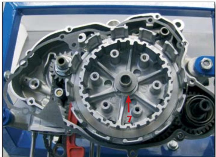
Öffnen Sie mit einem Schraubenzieher die Zungen des Sicherungsblechs (10) der Befestigungsmutter (9) für die Kupplungsnabe (11) und lösen Sie die Mutter unter Verwendung des speziellen Haltewerkzeugs für die Kupplungsnabe.
