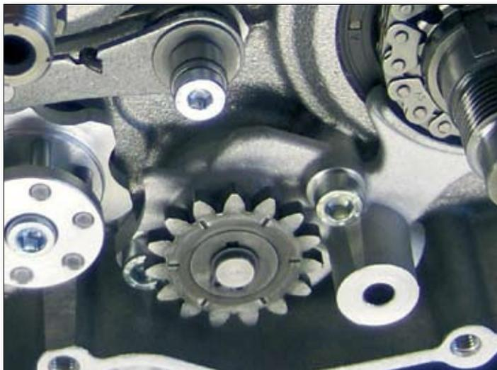
Setzen Sie den Deckel (4) auf, nachdem Sie die Öffnung mit dem Öl-Expansionsstopfen (5) verschlossen haben, und ziehen Sie die Schrauben M6x20 (6) und M6x15 (7) auf 10 Nm an.
