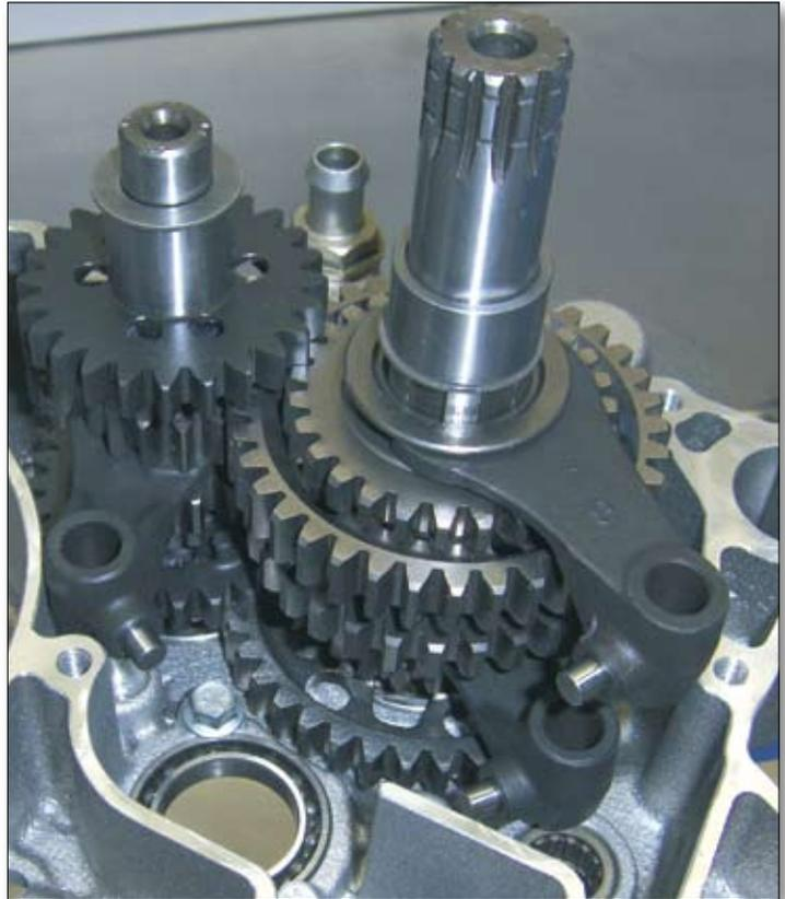
Kontrollieren Sie die Führungen in der Schaltwalze auf Verschleiß. Positionieren Sie die Walze in ihrem Lager und die Stifte in den Führungen. Drücken Sie die beiden Wellen durch die Schaltgabeln; achten Sie dabei darauf, die längere Welle für die Gabel auf der Nebenwelle zu verwenden.
