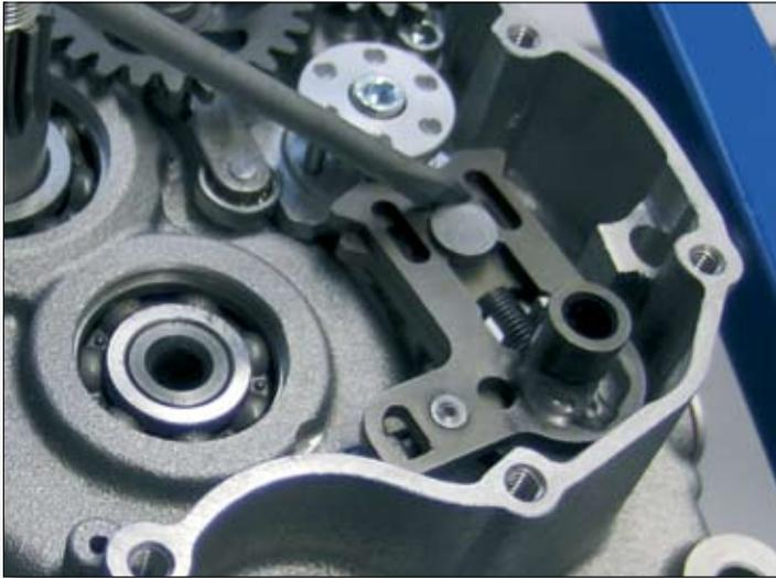
Ziehen Sie die Schaltwelle (1) heraus, wobei Sie die bewegliche Klinke mit einem Schraubenzieher zurückdrücken, damit sie dem Schaltstern nicht im Wege ist.
