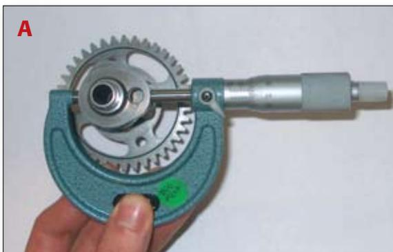
Messen Sie die maximale Nockenlänge (A) und den Grundkreisdurchmesser (B).
