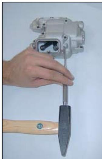
Montieren Sie den Einlasskipphebel (2) und den Auslasskipphebel (3) gemäß Abbildung und setzen Sie die zuvor gut mit Motoröl eingeeilten Anlaufscheiben 12x17x0.5 (7) zwischen die Kipphebel und den Zylinderkopfdeckel.
