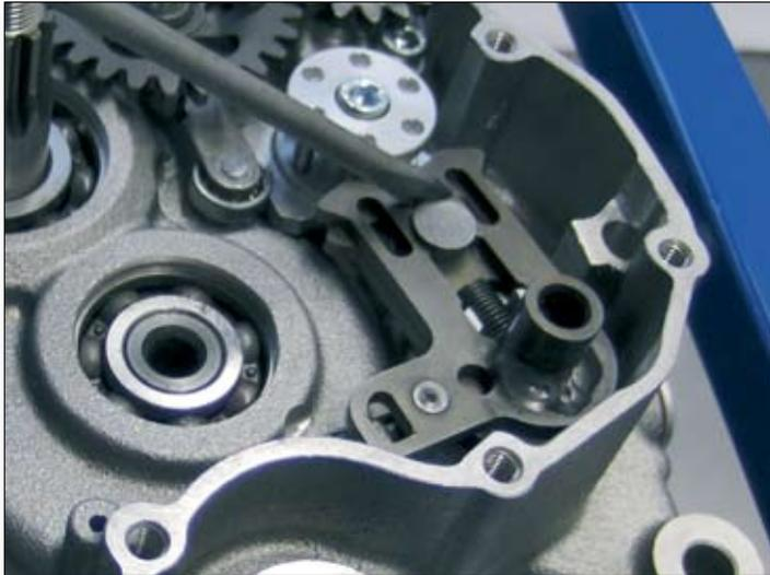
Setzen Sie die gut eingölte Schaltwelle in die entsprechenden Rollenlager und drücken Sie die bewegliche Klinke zurück, so dass sie die korrekte Position gegen den Schaltstern einnehmen kann und die Schaltwelle ganz an den Anschlag kommt. Bevor Sie diese Teile zusammenbauen, müssen Sie die Anlaufscheibe 14x30x1 auf die Welle setzen. Richten Sie die Welle so aus, dass sich die Enden der Feder (A) auf beiden Seiten der Haltenase (B) am Kurbelgehäuse befinden.
