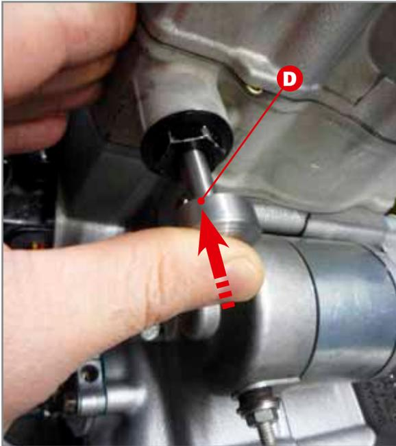
**Entriegelung des Spanners mit dem Spezial-Werkzeug D**
