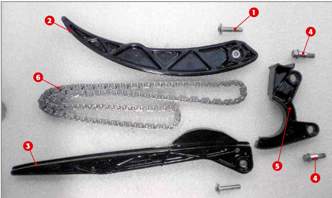
1) Die beiden Befestigungsschrauben der Führung; 2) Bewegliche Kettenführung; 3) Feste Kettenführung; 4) Schrauben des Kettenschutzes (mit Buchsen); 5) Kettenschutz; 6) Steuerkette.
