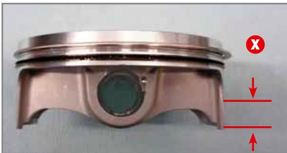
Höhe an welcher der Kolbendurchmesser gemessen wird.
