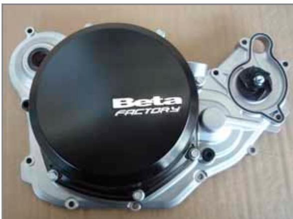
*Innerer Kupplungsdeckel mit Wasserpumpe.*
