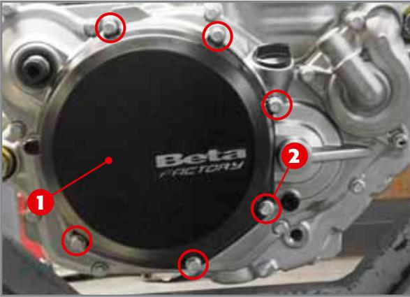
Der äußere Kupplungsdeckel 1 und die entsprechenden Schrauben 2.
