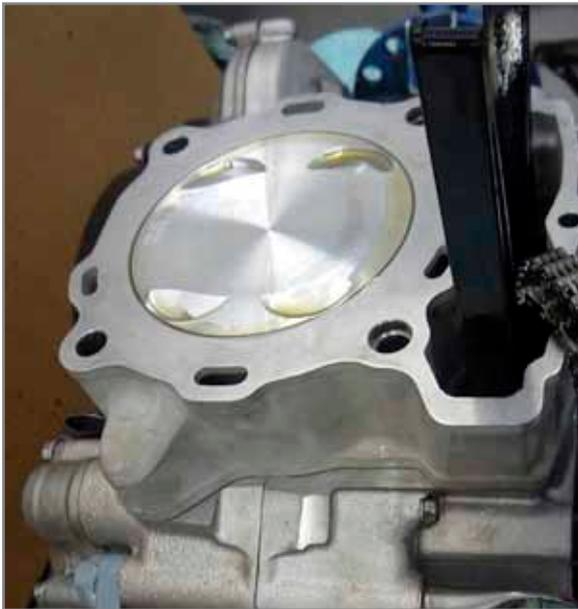
*Verbindung des Zylinders am Gehäuse.*
