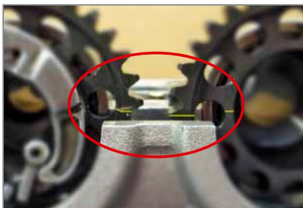
**Detailansicht der korrekten Ausrichtung der eingravierten Markierungen an den Zahnrädern der Nockenwellen.**
