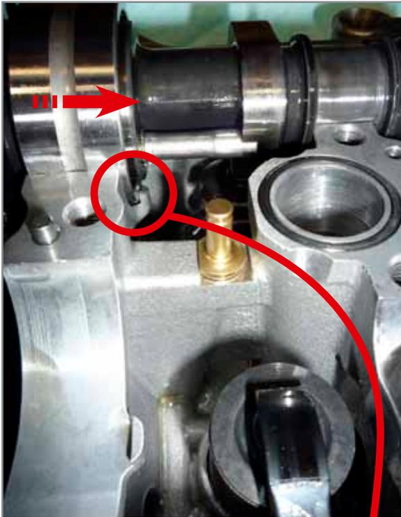
*Positionierung des Lagers der Nockenwelle.*
