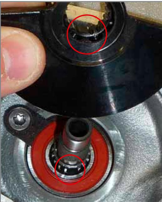
**Detailansicht der Verzahnungsprofile für die Verbindung**
