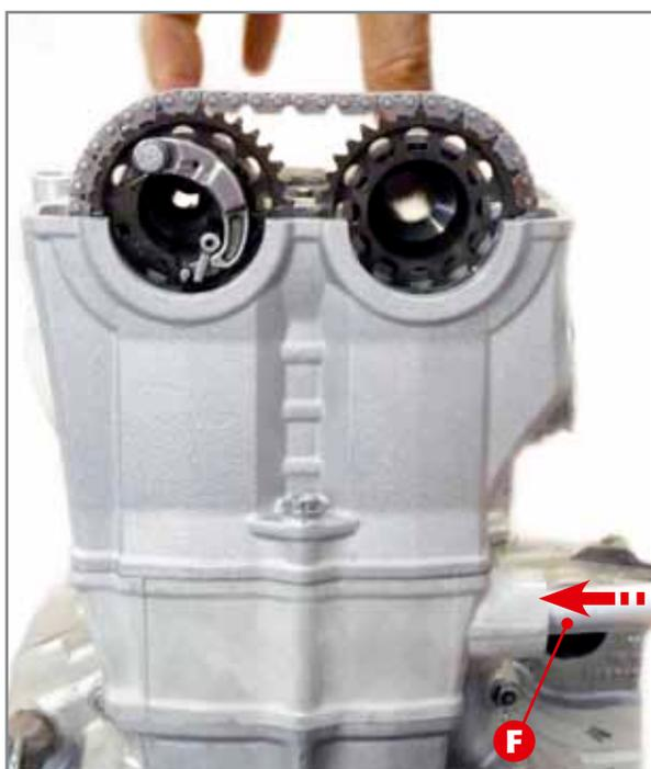
**Überprüfung der Nockenwellenstellung. Leichtes Spannen der Steuerkette**
