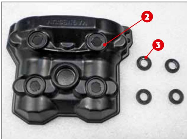
Der Zylinderkopfdeckel 2 und die vier Dichtungen 3.
