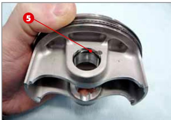
Anbringen der Sicherungsringe am Kolben.
