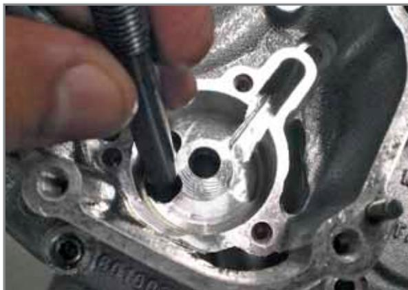
Entfernung auf der Ansaugseite der Ölpumpe.
