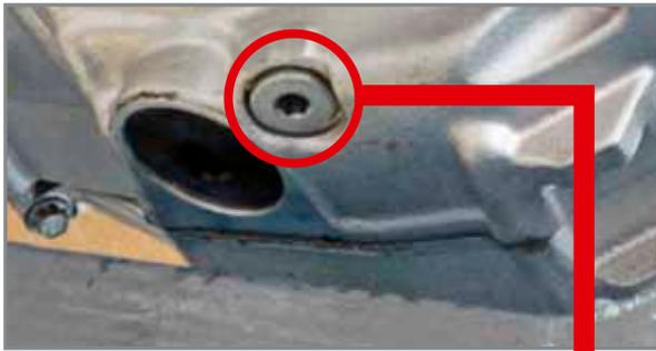
Position des Druckregelventils.
