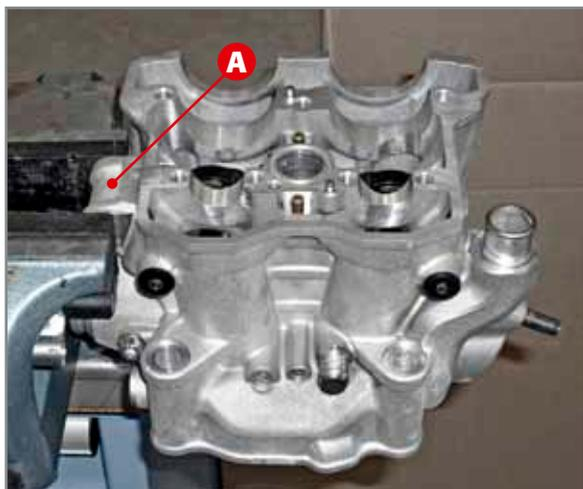
*Blockieren des Zylinderkopfes im Schraubstock.*
