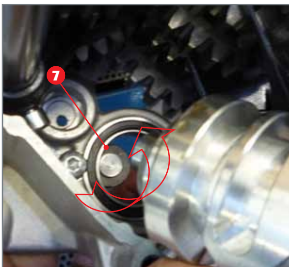
Die Zwangsteuervorrichtung in das entsprechende Lager einsetzen. Die Drehrichtung der Gangsperrhebel 7 beachten.
