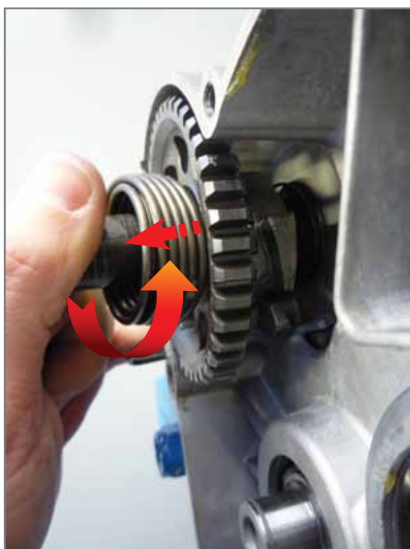
Entfernung der Welle aus dem Gehäuse.
