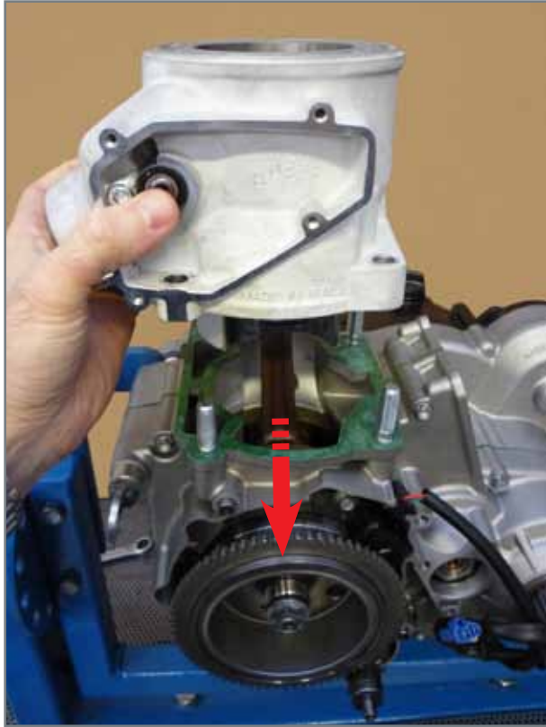
Kupplung Zylinder an Kolben und Gehäuse.
