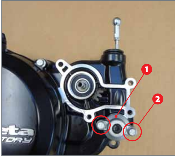
Entfernung des Einstelldeckels Pumpenlaufrad.
