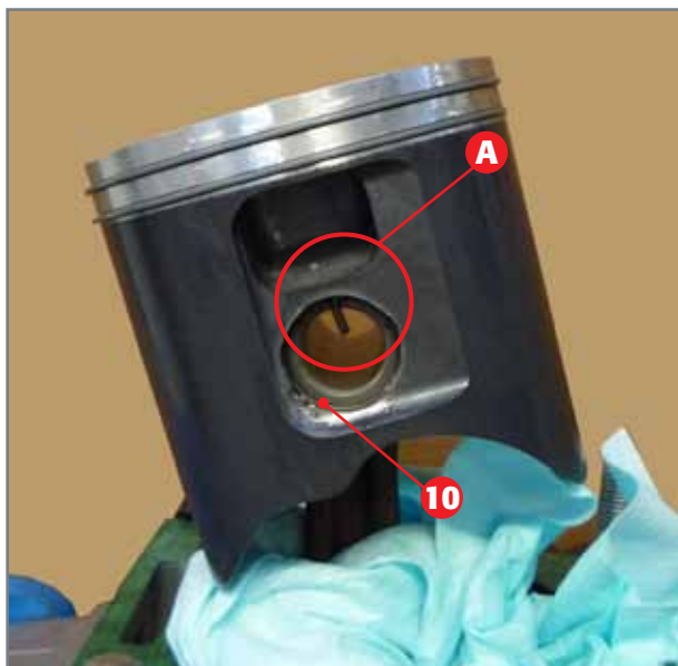
Entfernen Seegerring Kolben.
