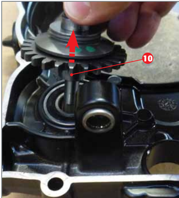
Herausziehen der Pumpenlaufradgruppe.
