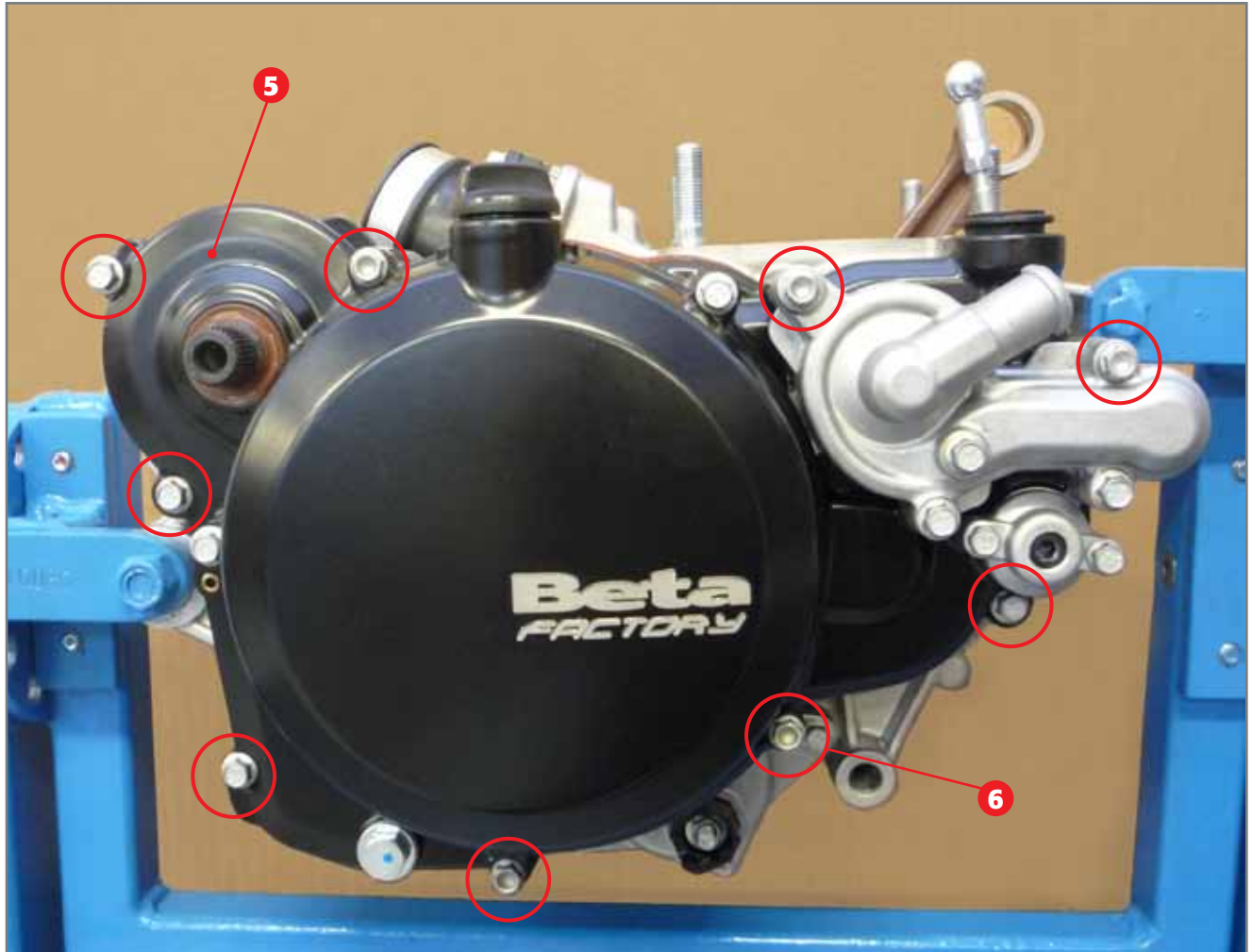
Schrauben innerer Kupplungsdeckel.
