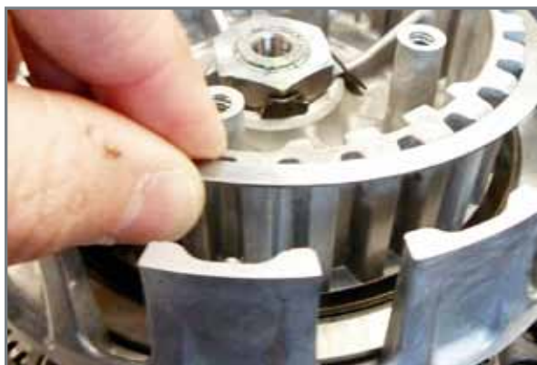
Entfernung der Spannscheibe.
