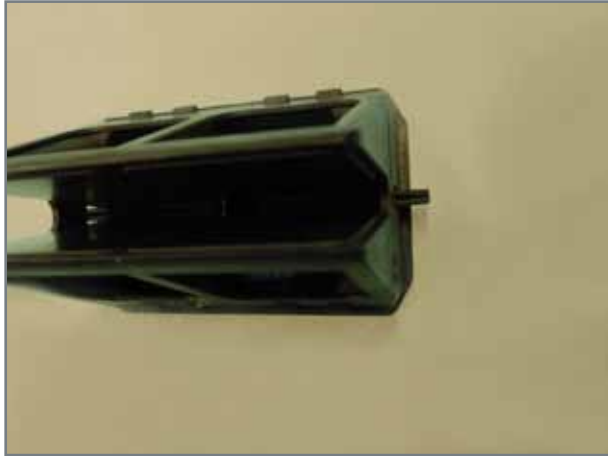
Abbau der zentralen Keile. In der Abbildung ist der Abzug eines einzelnen zu sehen.
