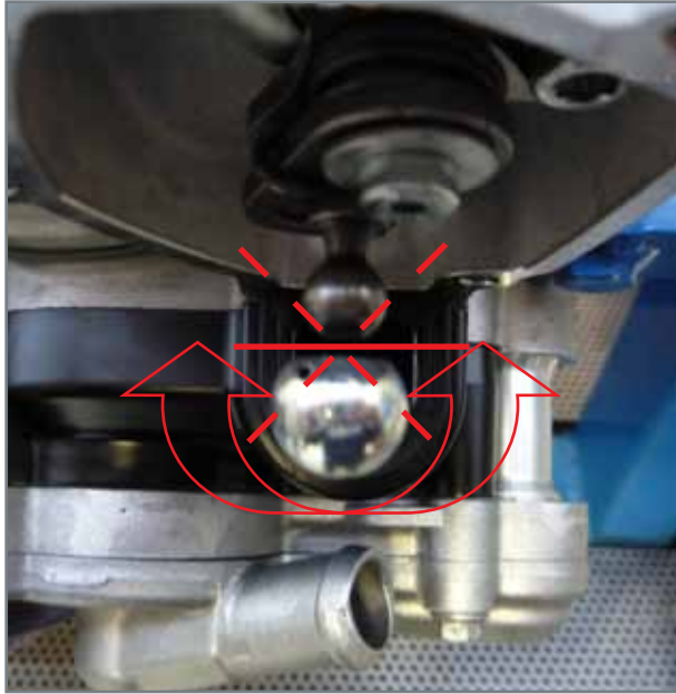
Überprüfung der Steuerstangendrehung.
