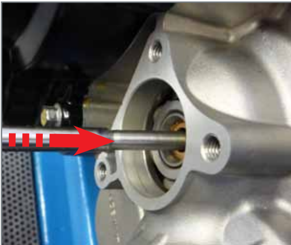
Einsetzen der Kupplungsstange.
