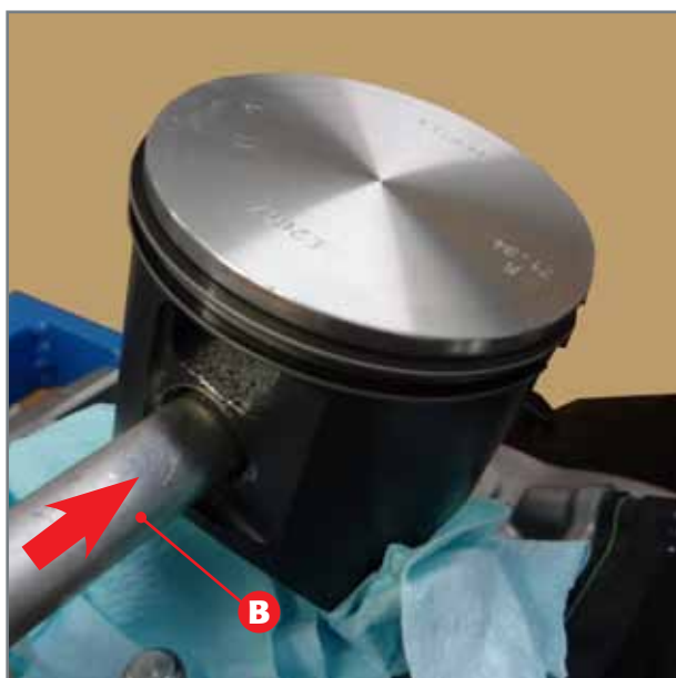
Entfernung des Kolbenbolzens.
