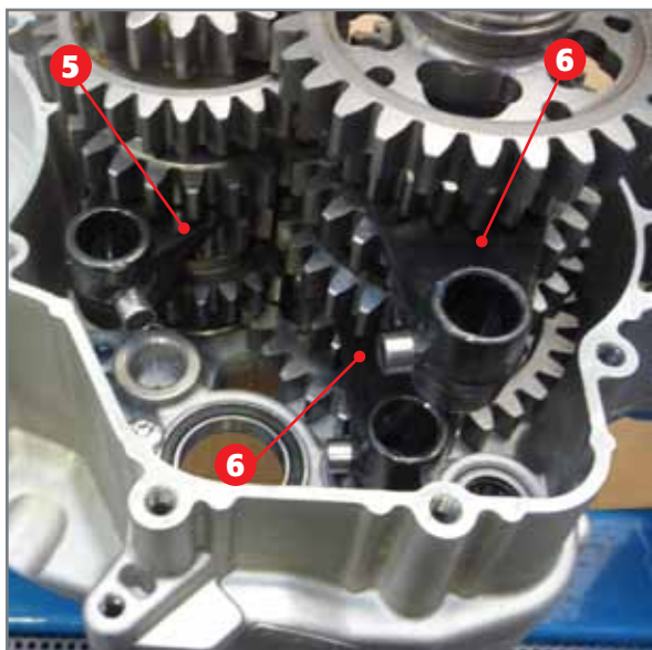
Anbringen der Schaltgabeln an den Zahnradern.
