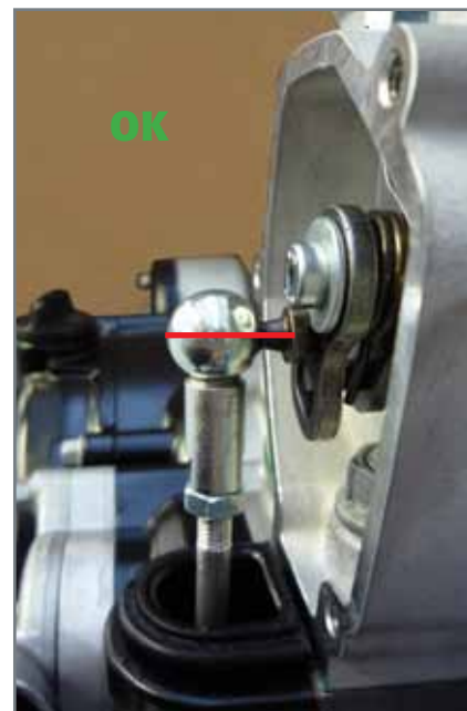
Richtige Stellung des Sitzes der Steuerstange.
