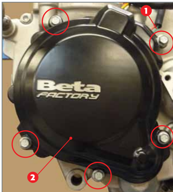
Befestigungsschrauben 1 des Schwungraddeckels 2.
