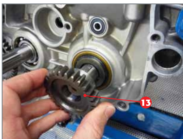
Entfernung des Primärgetriebes,
