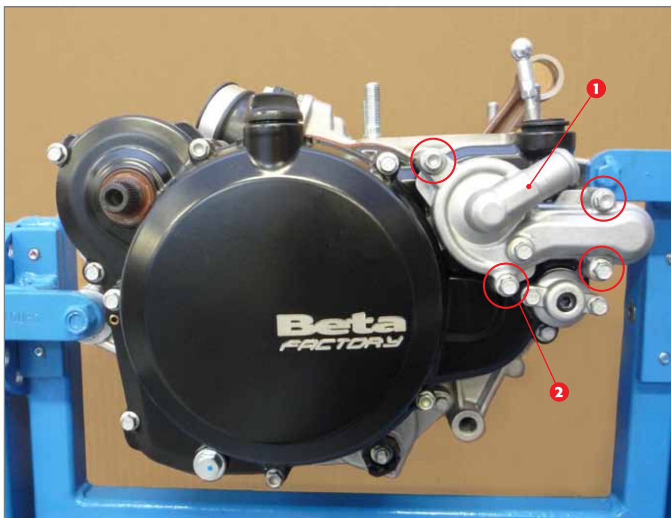
Schrauben Deckel der Pumpe für die Kühlflüssigkeit:
