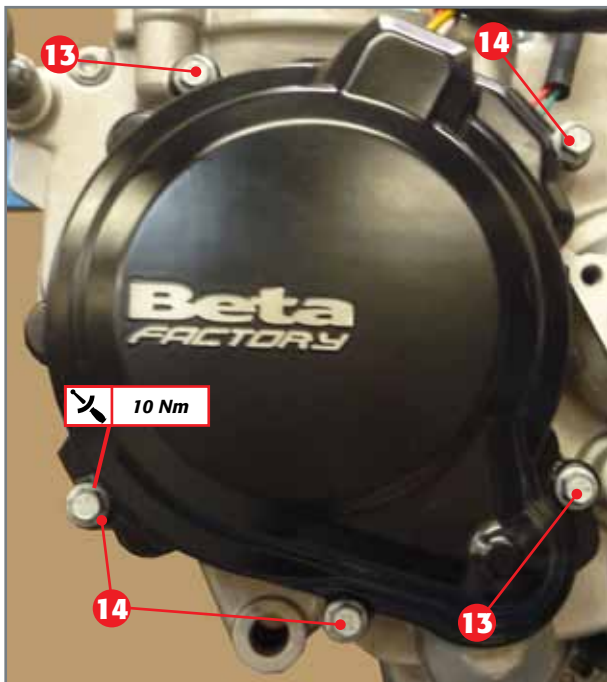
Schwungraddeckel am Gehäuse.
