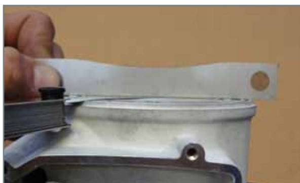
Falls Platte und Kolben sich nicht berühren: den Abstand zwischen Platte und Kolben überprüfen.
