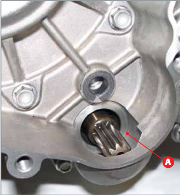
Auftragen von Öl.
