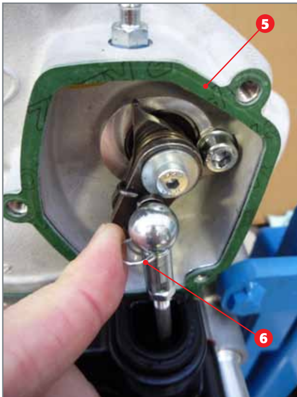
Einsetzen der Steuerstange und Anwendung des Endanschlags.
