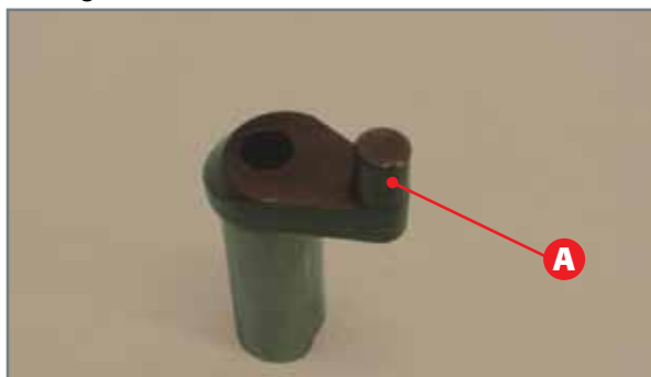
Bereich A Steuerhebel Pumpenlaufrad überprüfen.
