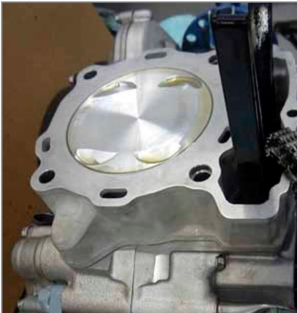
Verbindung des Zylinders am Gehäuse.
