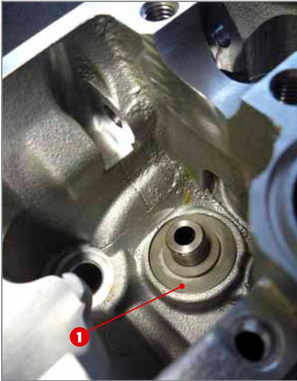
*Einsetzen des unteren Ventildfedertellers.*
