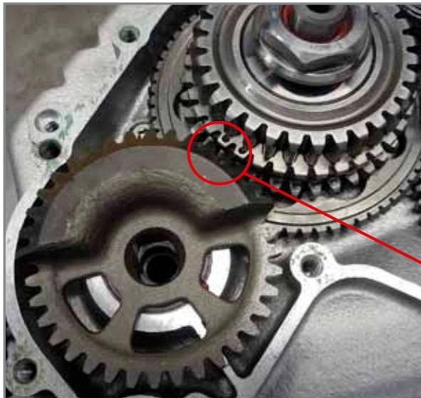
**Einbau der Ausgleichswelle.****2.11.6 ÜBERPRÜFUNG UND EINBAU DER AUSGLEICHSWELLE**
