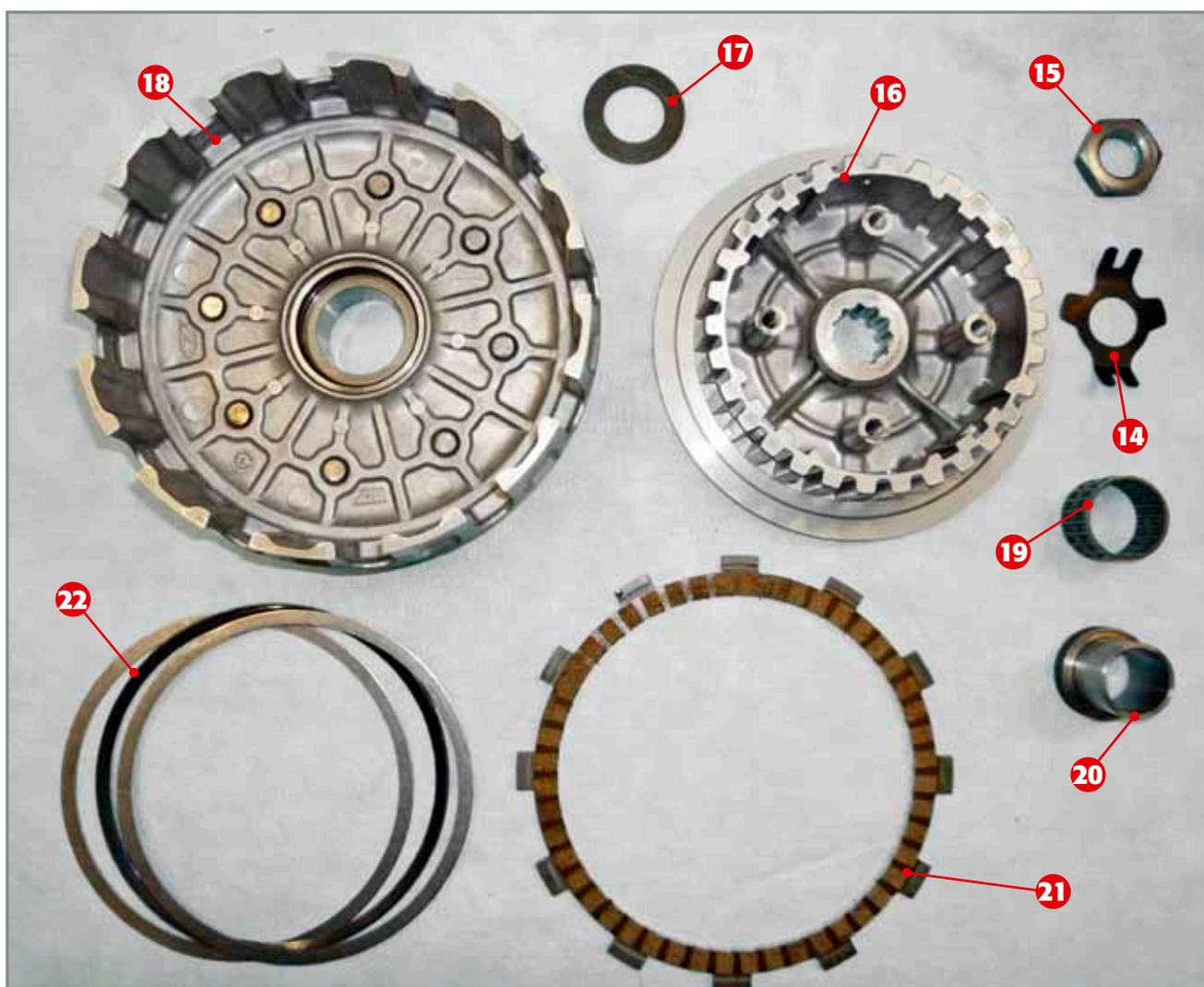
Sicherungsscheibe 14; Mutter 15; Kupplungstrommel 16; Scheibe 17; Kupplungskorb 18; Nadelkäfing 19; und Büchse 20; Spezielle Stahlscheibe 21; Spannscheibe 22.
