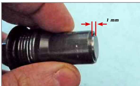
Überprüfen, dass der Kolben keine Anzeichen für ein anormales Festfressen zeigt. Den Kolben in die Halterung einsetzen und schieben, bis er circa einen Millimeter über den Rand der Halterung herausragt.
