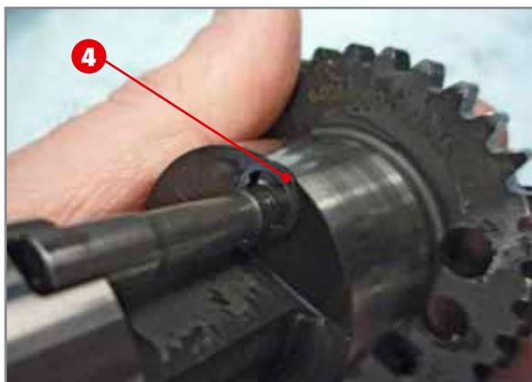
**Herausnehmen des Benzring-Rings aus der Welle des Dekompressors.**
