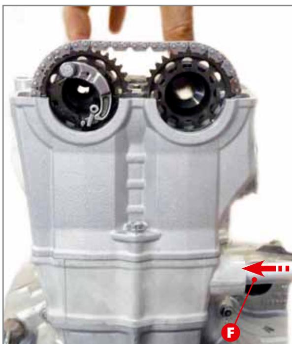
**Überprüfung der Nockenwellenstellung. Leichtes Spannen der Steuerkette**
