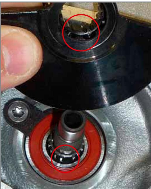
**Detailansicht der Verzahnungsprofile für die Verbindung**
