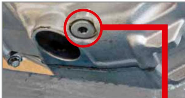
Position des Druckregelventils.
