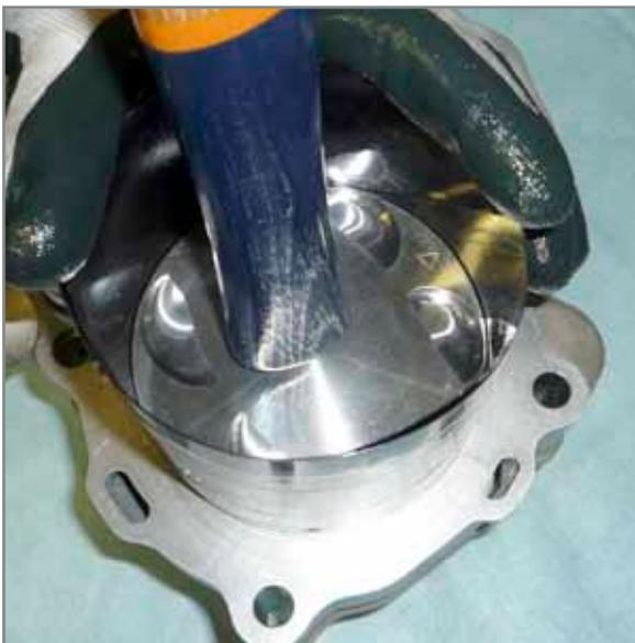
Einsetzen des Kolbens in den Zylinder.
