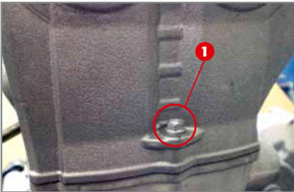
**Befestigungsschraube des Zylinderkopfes auf der Kettenseite.**
