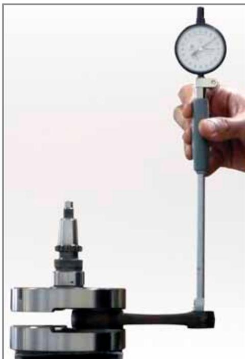
*Überprüfung des Innendurchmessers des Pleuelauges mit Bohrungsmesser.*
