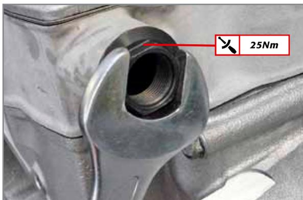
Die Halterung des Spanners in den entsprechenden Sitz am Zylinder einsetzen, mit 25 Nm anziehen und den Kolben in Richtung der Vorderseite des Motors drücken.
