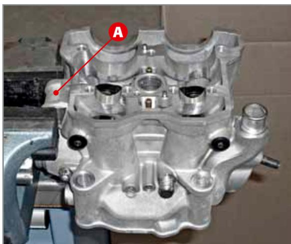
*Blockieren des Zylinderkopfes im Schraubstock.*
