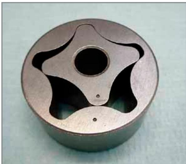
**Ölabsaugpumpe:** Die beiden Punkte an den Rotoren beachten. Der Punkt muss zur Innenseite des Motors zeigen.
