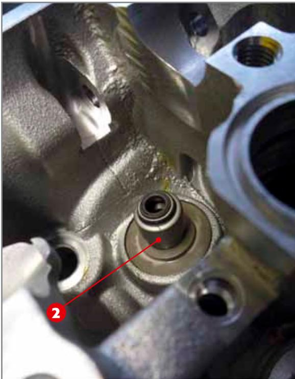
*Einsetzen der Ventilschaftdichtung.*
