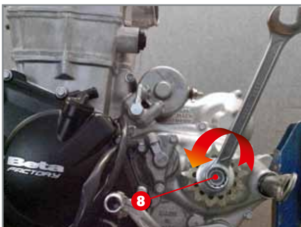
Drehen der Antriebswelle.
