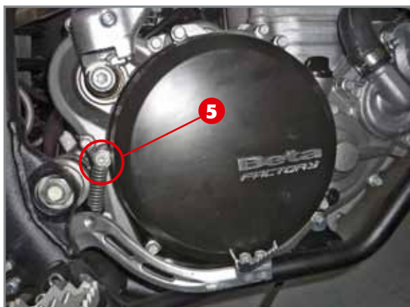
Detailansicht der Schraube 5, die anzubringen ist, wenn der Motor im Fahrzeug eingebaut ist.
