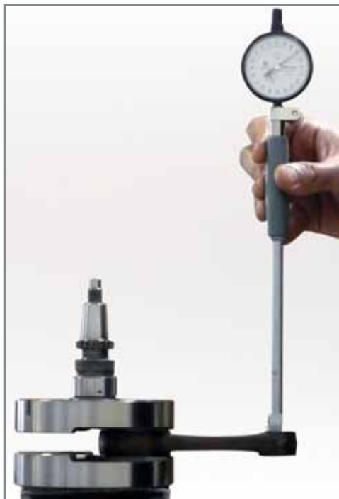
Überprüfung des Innendurchmessers des Pleuelauges mit Bohrungsmesser.
