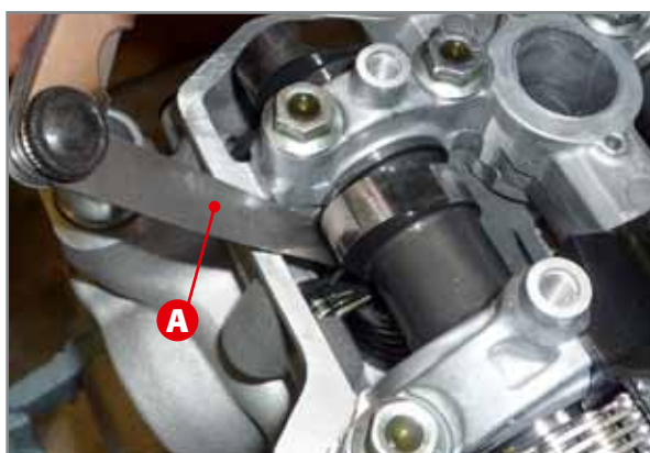
Überprüfung des Ventilspiels mit Dickenlehre
