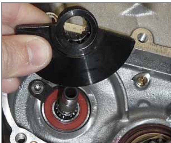
Anbringen des Gegengewichts an der Ausgleichswelle.
