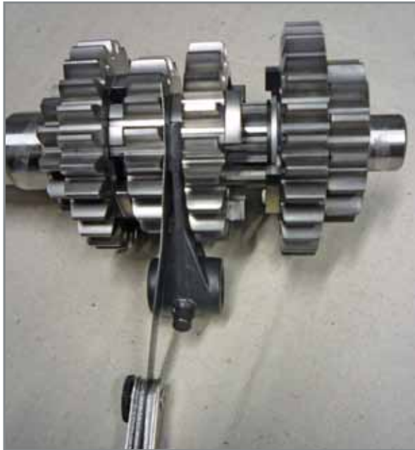
Überprüfung der Abnutzung der Schaltgabeln und der Zahnräder.
