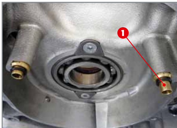
Position der Kolbenspritzdüsen.
