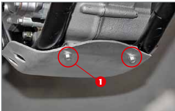
Vordere Befestigungsschrauben der Motorschutzabdeckung.
