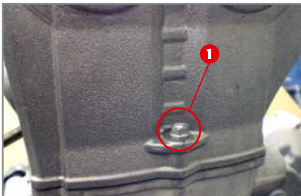
Befestigungsschraube des Zylinderkopfes auf der Kettenseite.
