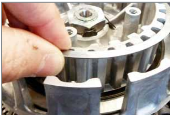
Entfernung der Spannscheibe.
