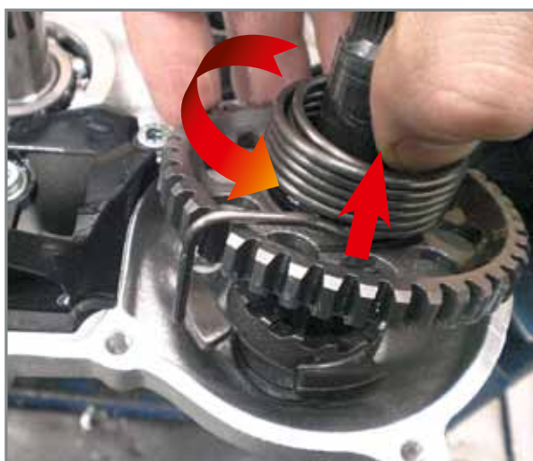
Entfernung der Welle aus dem Gehäuse.
