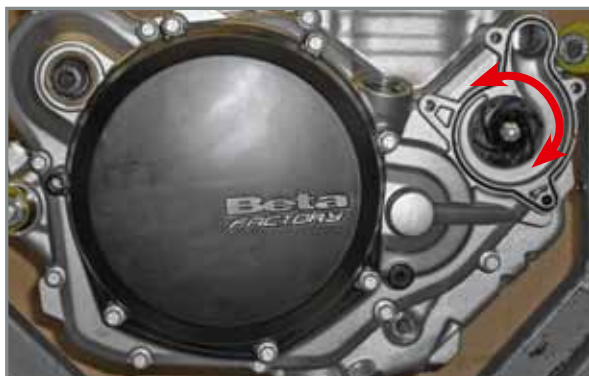
Anbringen des inneren Kupplungsdeckels an der rechten Gehäusehälfte.
