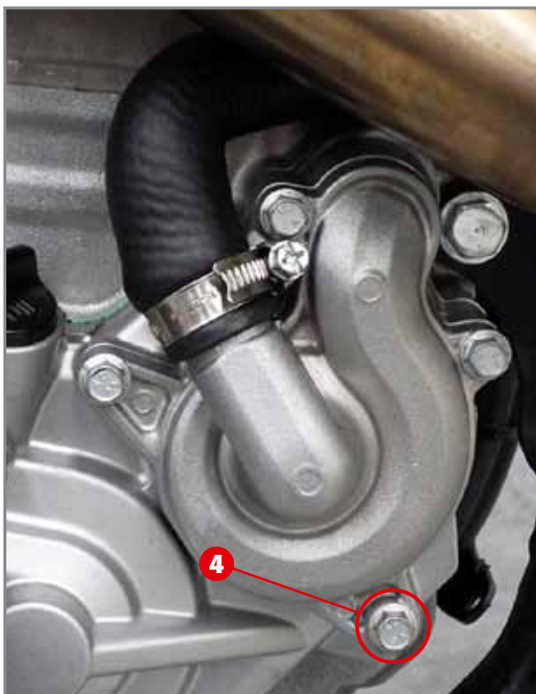
Ölablassschraube 4 der Kühlflüssigkeit.
