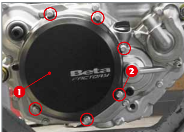
Der äußere Kupplungsdeckel 1 und die entsprechenden Schrauben 2.
