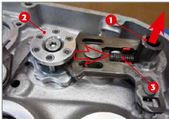
Entfernung der Schaltwelle.
