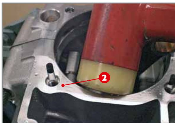
Zerlegen des Gehäuses.
