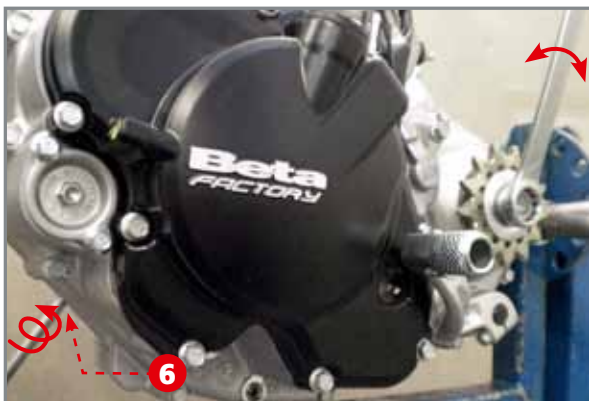
Blockieren der Kurbelwelle am OT. Beachten Sie Sperrschraube 6 und die Bewegung, die auf die mit dem Maulschlüssel auf die Antriebswelle ausgeübt wird.
