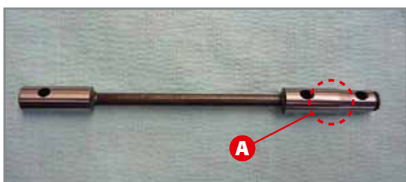
Überprüfung der Antriebswelle der Ölpumpe.
