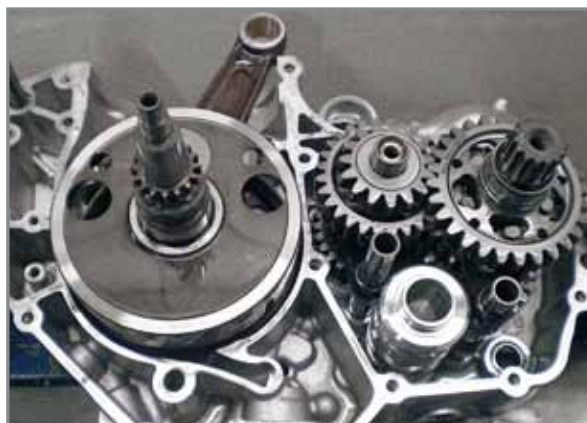
Die rechte Gehäusehälfte (Innenseite) mit Kurbelwelle und Schaltung.
