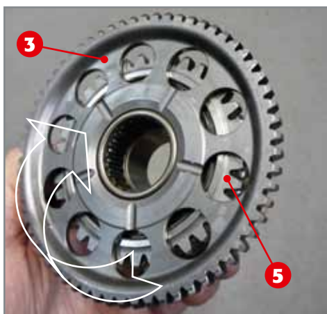
Primärrad mit Freilauf und Freilaufzahnrad.
