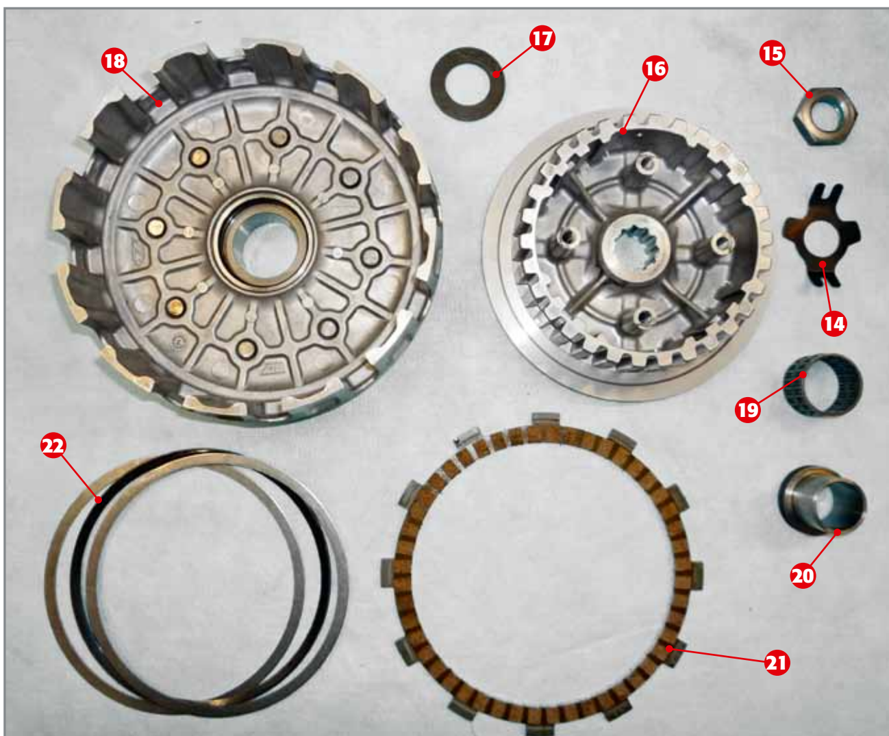
Sicherungsscheibe 14 ; Mutter 15 ; Kupplungstrommel 16 ; Scheibe 17 ; Kupplungskorb 18 ; Nadelkäfig 19 ; und Büchse 20 ; Spezielle Stahlscheibe 21 ; Spannscheibe 22 .
