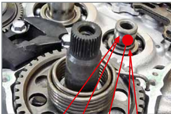
Einsetzen der Kickstarterfeder.
