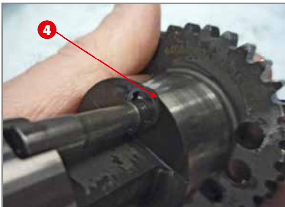
Herausnehmen des Benzing-Rings aus der Welle des Dekompressors.
