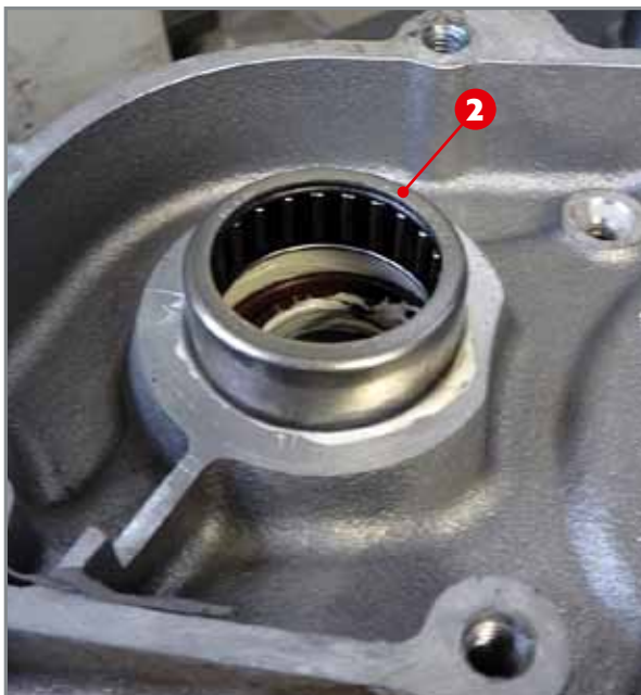
Einsetzen des Lagers 2.
