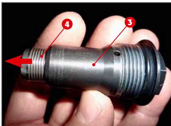
Halterung des Spanners mit Kolben.
