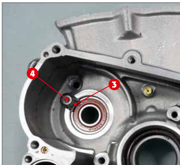
Halteblech der Ausgleichswelle außen an der linken Gehäusehälfte.
