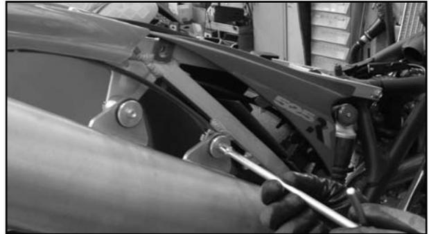
Die Sperrfeder Schalldämpfer/ Auspuffrohr entfernen.
