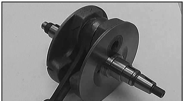
Wird die Kurbelwelle wiederverwendet, muss der Fluchtungsfehler der Halbwellen geprüft werden. Zu diesem Zweck muss die Kurbelwelle an einer Rollen-Auswuchtmaschine oder ähnlichem angebracht werden und der Fluchtungsfehler mit einer Messuhr an den Achsenenden der Halbwellen geprüft werden.
