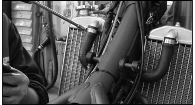
Anschließend die Schelle abnehmen (siehe Abbildung) und die untere Leitung ausbauen.
