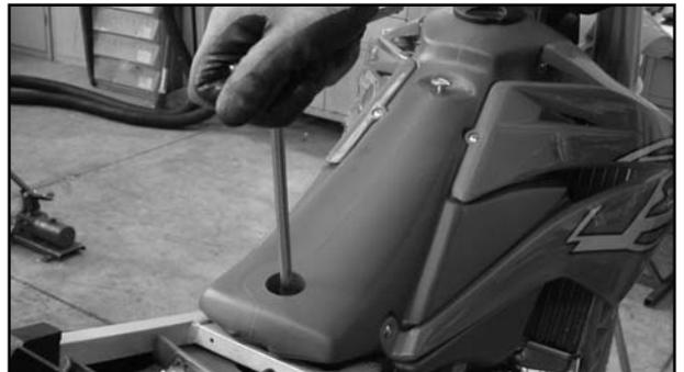
Zuerst den Benzinhahn schließen, die Benzinleitung abziehen und dann den Tank ausbauen.
