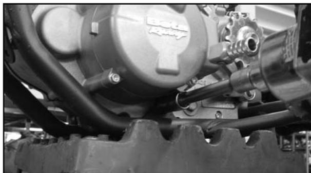
Den oberen Verbindungsbolzen Motor/ Rahmen entfernen.
