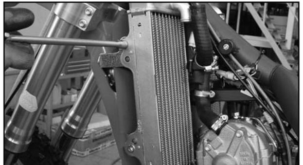
Die beiden Schrauben **1** abschrauben und den linken Kühler ausbauen.
