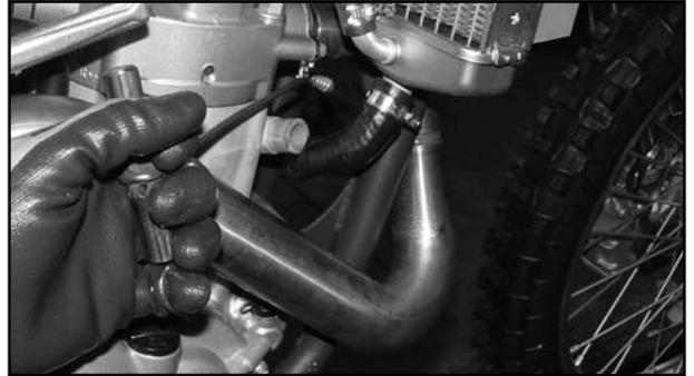
Die Befestigungsschraube des Auspuffrohrs am Rahmen abschrauben.
