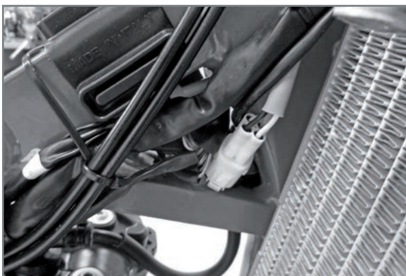
Elektrische Verbinder in getrenntem Gehäuse (Vergaserversionen).
