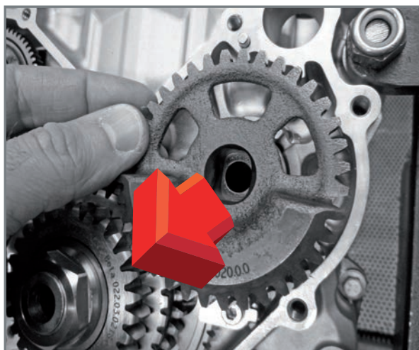
Extraction de l'arbre d'équilibrage.
