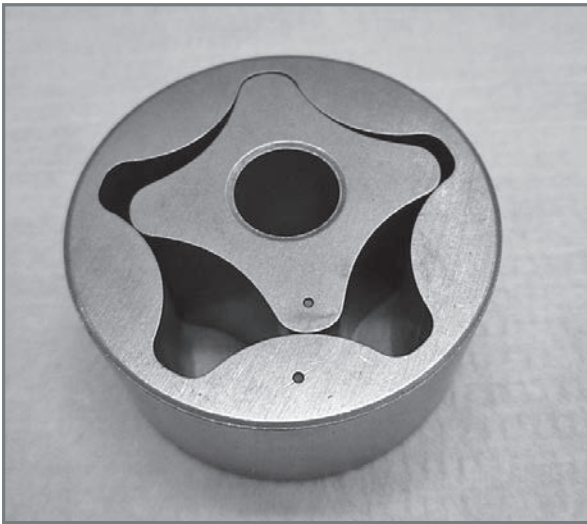
Ölabsaugpumpe: Die beiden Punkte an den Rotoren beachten. Der Punkt muss zur Innenseite des Motors zeigen.
