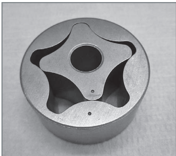
Pompe aspirante huile: à noter la pointe présente sur les deux rotors. La pointe doit être tournée vers l'intérieur du moteur.
