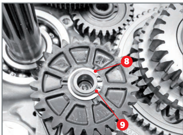
Einbau des Antriebszahnrad der Ölpumpe.
