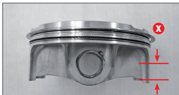
Hauteur à laquelle effectuer la mesure du diamètre extérieur du piston.
