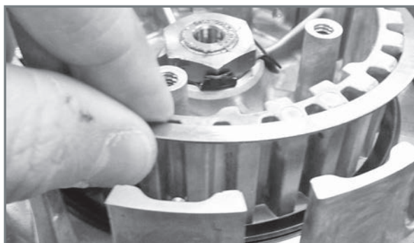
Enlèvement de l'ensemble rondelle ressort.
