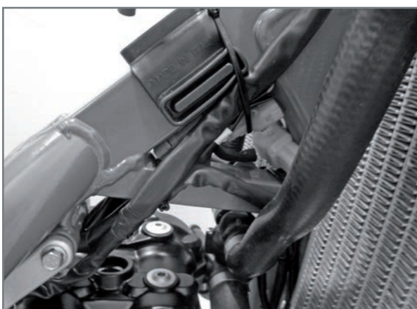
Elektrische Verbinder in getrenntem Gehäuse (Einspritzversionen).
