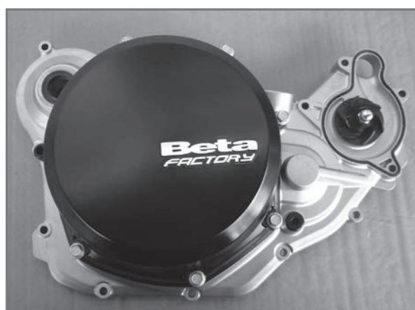
Innerer Kupplungsdeckel mit Wasserpumpe.
