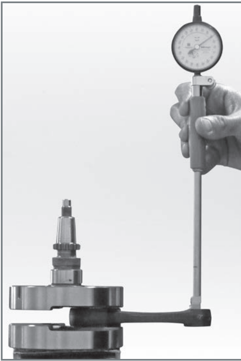
Überprüfung des Innendurchmessers des Pleuelauges mit Bohrungsmesser.
