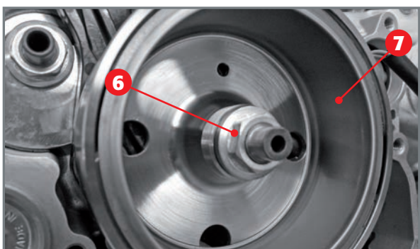
Die Mutter 6, die das Schwungrad 7 an der Motorwelle befestigt (Vergaserversion).
