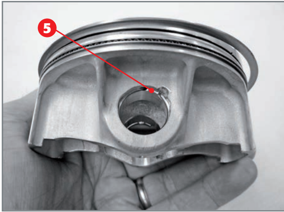
Anbringen der Seegerringe 5 am Kolben.
