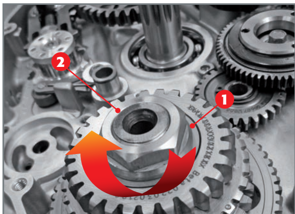
Primärrad 1 und entsprechende Mutter 2.
