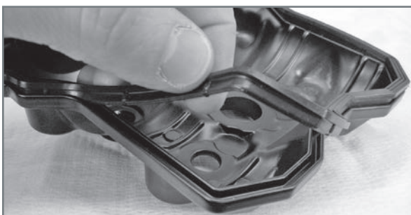
Montage du joint dans la gorge présente sur le couvre- culasse.
