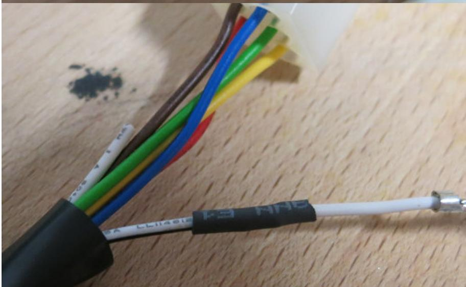
Den Pin nun in den noch freien Steckplatz einrasten und das Isolierband wieder anbringen. Achtung: das abgeschnittene weisse Kabel ist bei eingeschaltetem Licht spannungsführend und **muss so isoliert werden** dass es danach nicht irgendwo beim Einbau an den Rahmen kommen kann (Kurzschluss)
